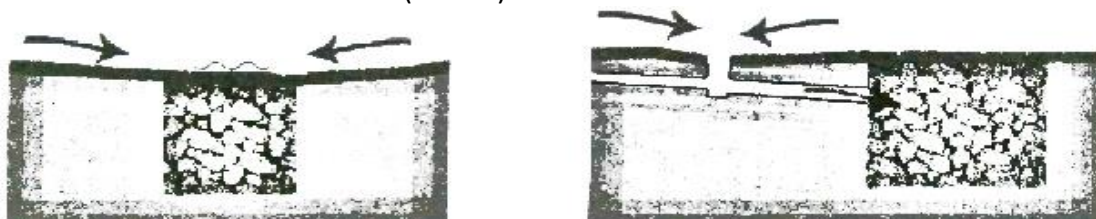
Figura 6 – Modos de introdução da água nos poços: pelo escoamento direto (esquerda) e pela rede de condutos do sistema (direita).
