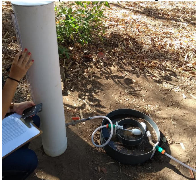
Figura 17 – Dispositivos de boias que controlam o nível de água dos anéis.
