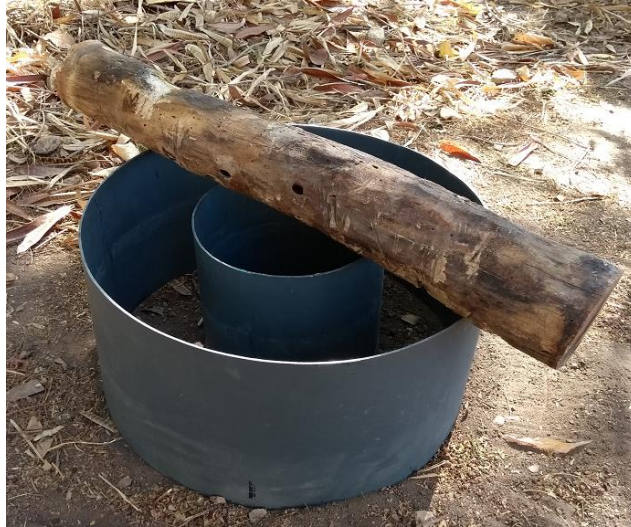
Figura 16 – Anéis metálicos do Infiltrômetro em posição para cravação no solo.
