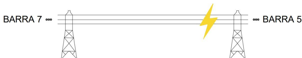
Figura 8 – Falta aplicada a 90% da linha de 200km - Barra 7 como referência.
