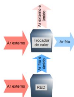
Figura 3 – Resfriado Evaporativo Indireto
