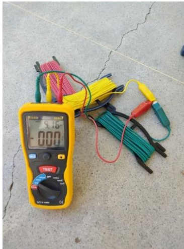
Figura 48 – Curto entre os cabos e ajuste do terrômetro
