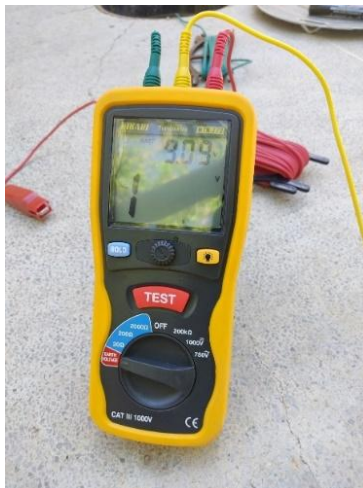
Figura 47 – Conexão dos cabos de testes verde, amarelo e vermelho
