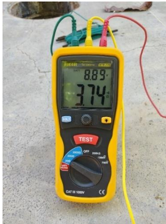
Figura 51 – Exemplo de medição da resistência de aterramento
