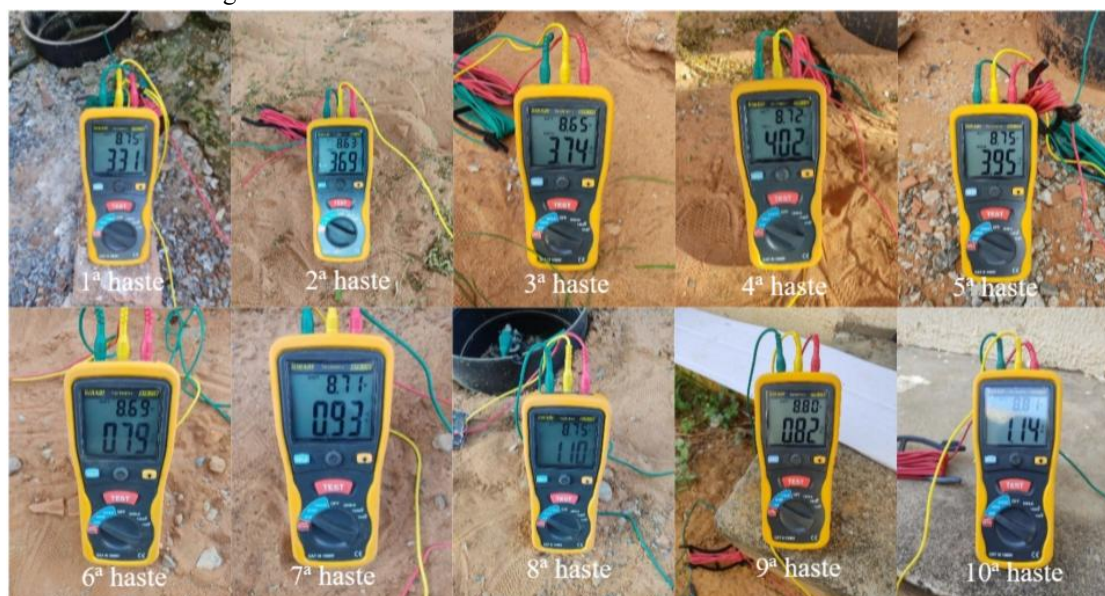
Figura 53 – Resistências medidas nas hastes do módulo laboratorial
