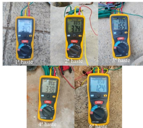
Figura 55 – Resistências medidas nas hastes do módulo didático
