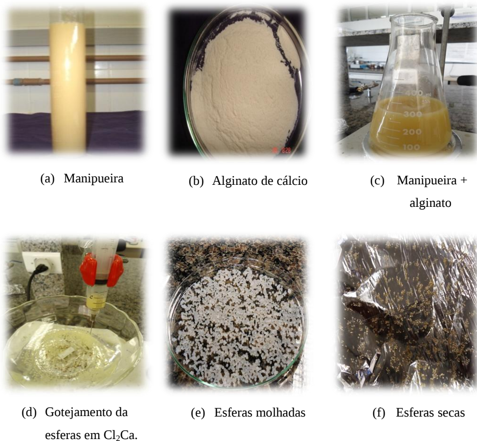
Figura 7: Esquema do processo de imobilização por aprisionamento em alginato do complexo enzimático.
