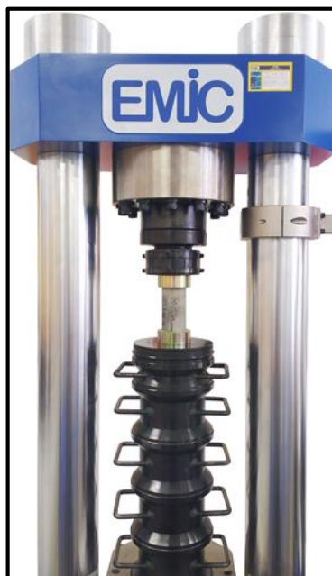
Figura 13 – Corpo-de-prova disposto na prensa hidráulica para ensaio de resistência à compressão
