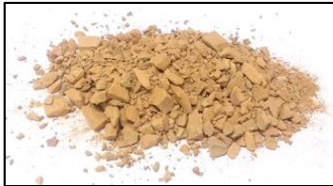
Figura 3 – Rejeitos de blocos cerâmicos de vedação fragmentados por meio de apiloador manual.
