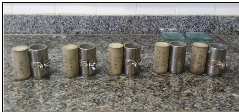
Figura 12 – Corpos-de-prova de argamassa após a desmoldagem.
