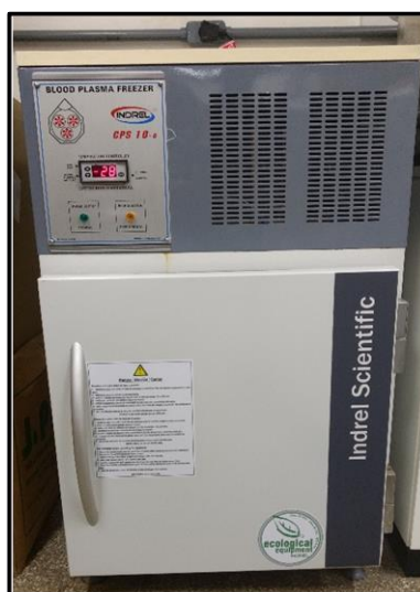
Figura 10 – Freezer utilizado para paralisar as reações da pasta de hidróxido de cálcio e RCV.
