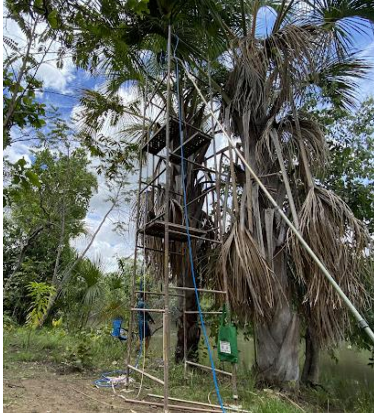
Figura 14 – Torre de andaimes utilizada para variação da altura total de elevação.
