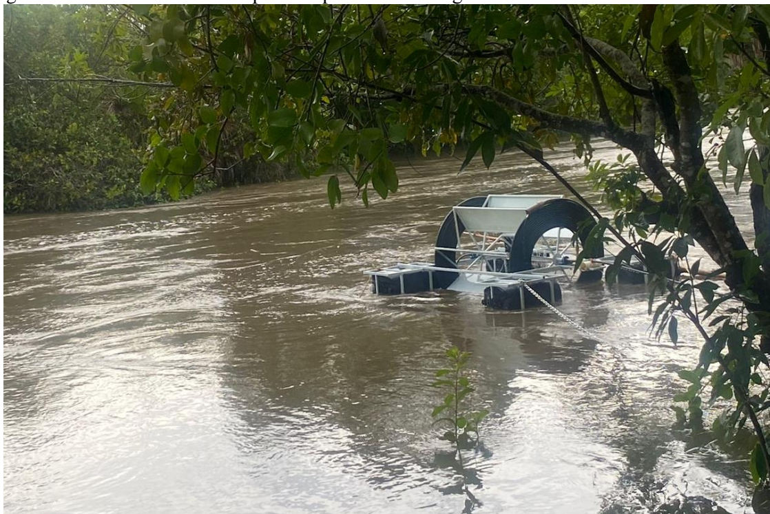
Figura 12 – Bomba de bobina espiral acoplada à roda d'água flutuante instalada no rio de Ondas.
