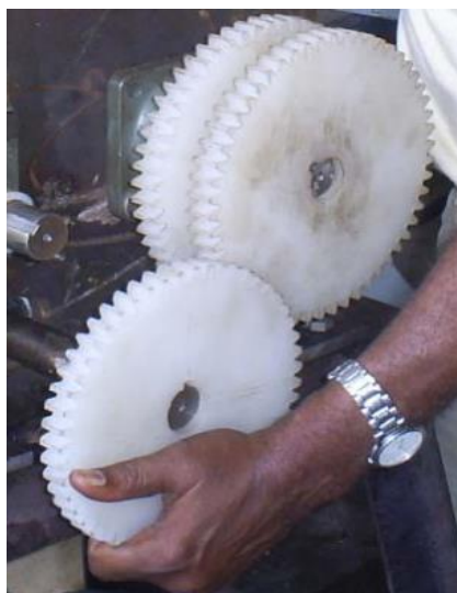
Figura 11: Engrenagens de Nylon que compõem o sistema de transmissão da máquina
