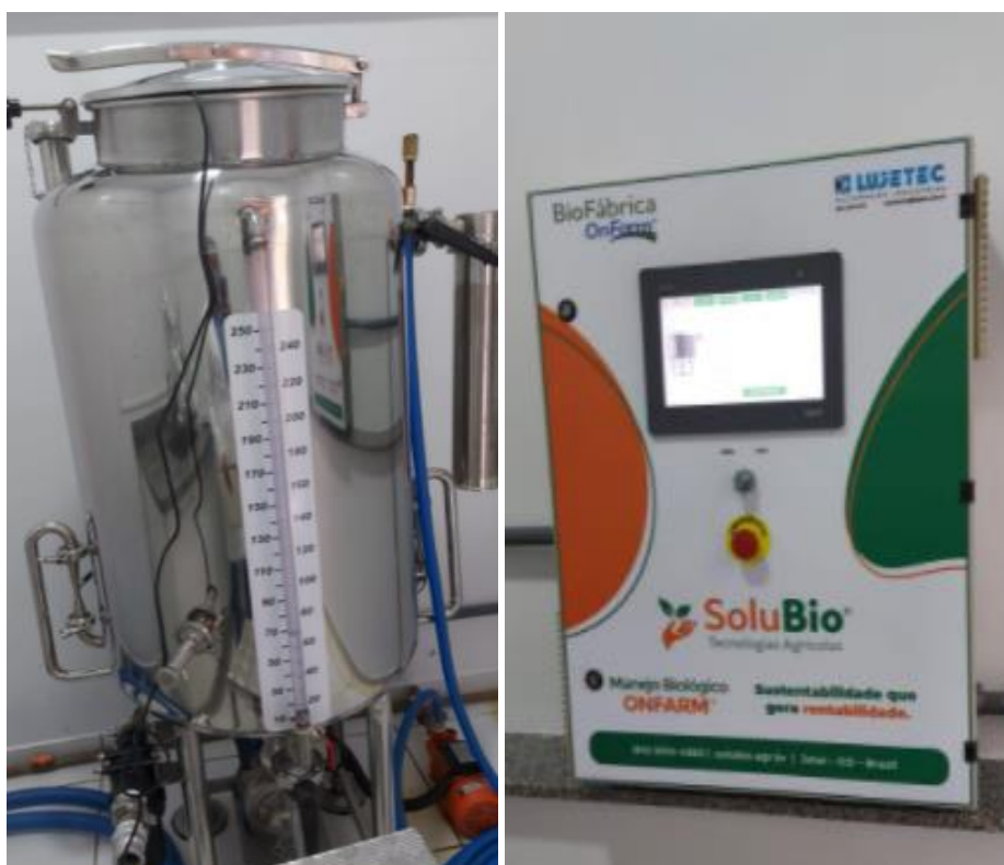
Figura 5.1: Biorreator de 250 L utilizado na multiplicação.
