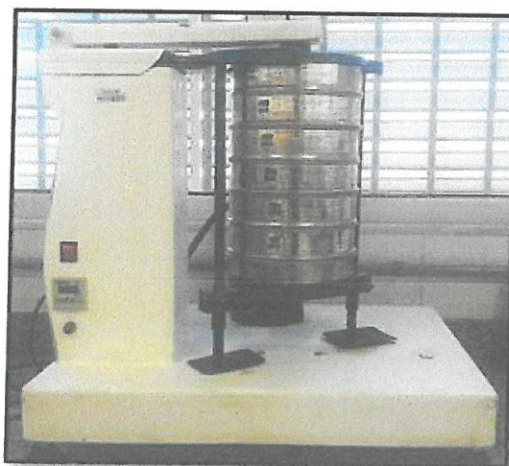
Figura 3 – Agitador de peneiras utilizado para a separação da fração de partículas com dimensão inferior a 75 \mu\text{m} .
