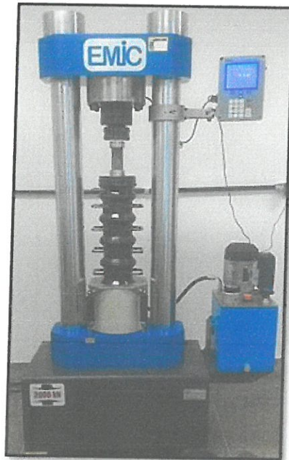
Figura 10 – Prensa hidráulica utilizada no ensaio de resistência à compressão axial.
