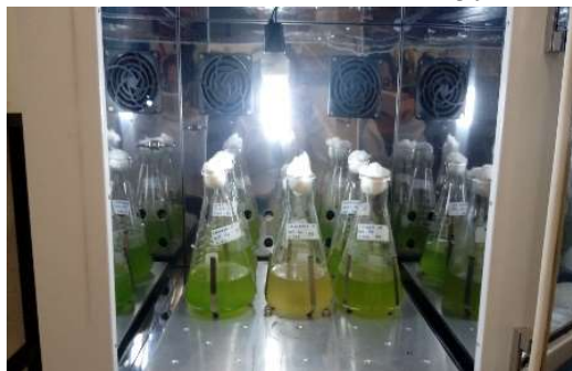
Figura 10. Inóculos iniciais das microalgas Chlamydomonas sp. e Scenedesmus sp. acondicionados na incubadora automática orbital MSM 130/PGA/F.
