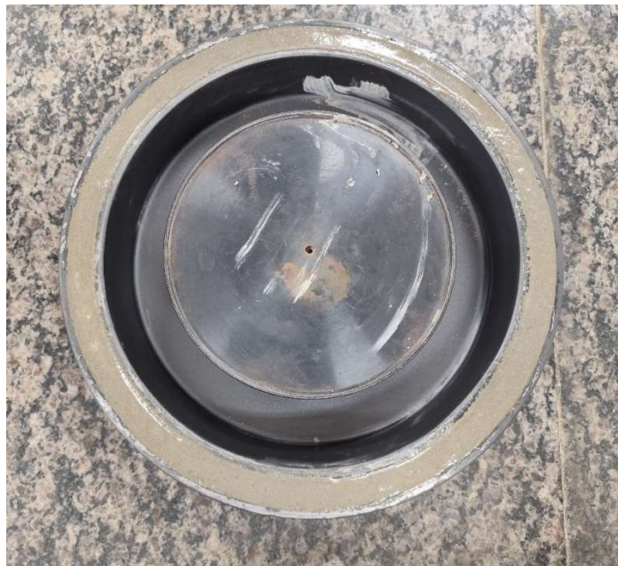
Figura 27: Anel de argamassa produzido para medir o indicador de fissuração em argamassas.
