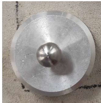
Figura 26: Pastilha circular metálica para ensaio de aderência da argamassa.
