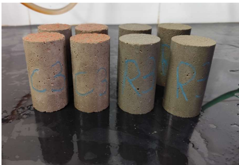
Figura 18: Corpos de prova retificados para ensaio de resistência à compressão.
