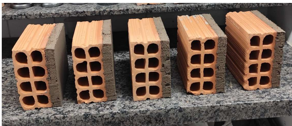
Figura 15: Blocos cerâmicos rebocados para extração dos corpos de prova para os ensaios de resistência potencial de aderência à tração.
