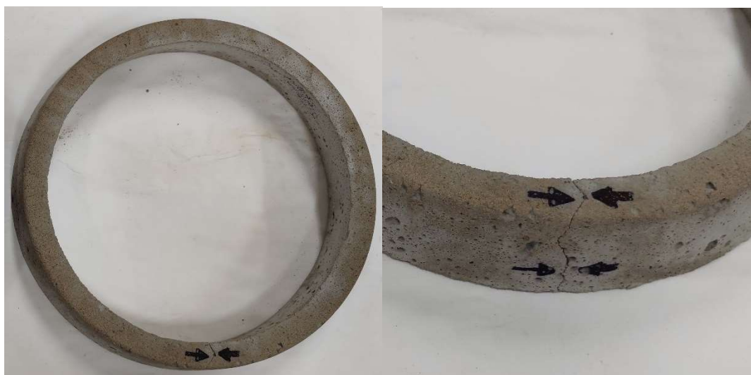
Figura 54: Anel de argamassa referência 1,0:4,5:0,80.
