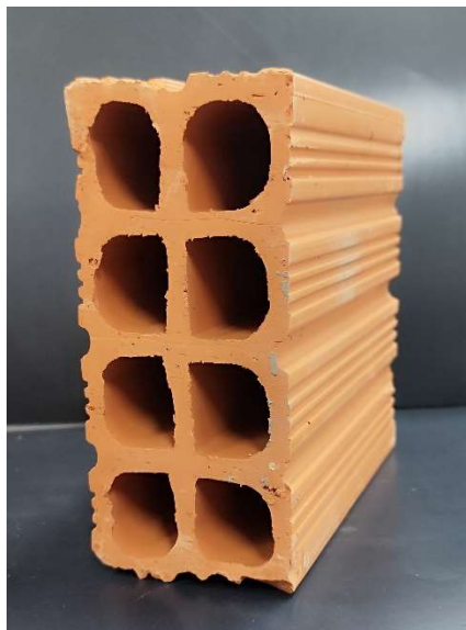
Figura 10: Bloco cerâmico utilizado como substrato no estudo.
