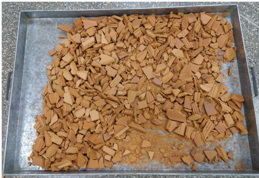
Figura 5: Resíduo de cerâmica vermelha após fragmentação com marreta.
