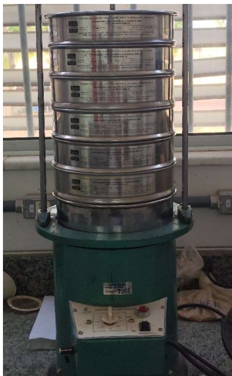
Figura 12: Agitador mecânico para determinação da composição granulométrica de agregados miúdos.
