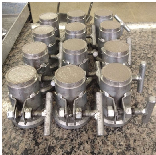
Figura 14: Moldagem dos corpos de prova cilíndricos Ø5cm x 10cm para ensaios.
