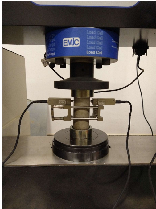
Figura 19: Execução do ensaio de módulo de elasticidade com o deflectômetro acoplado ao corpo de prova.
