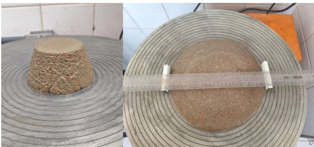
Figura 17: Índice de consistência da argamassa com RCV, pré e pós a aplicação dos impactos.
