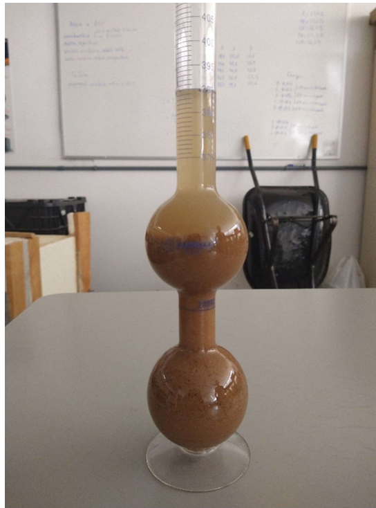
Figura 11: Massa específica da areia pelo frasco de Chapman.
