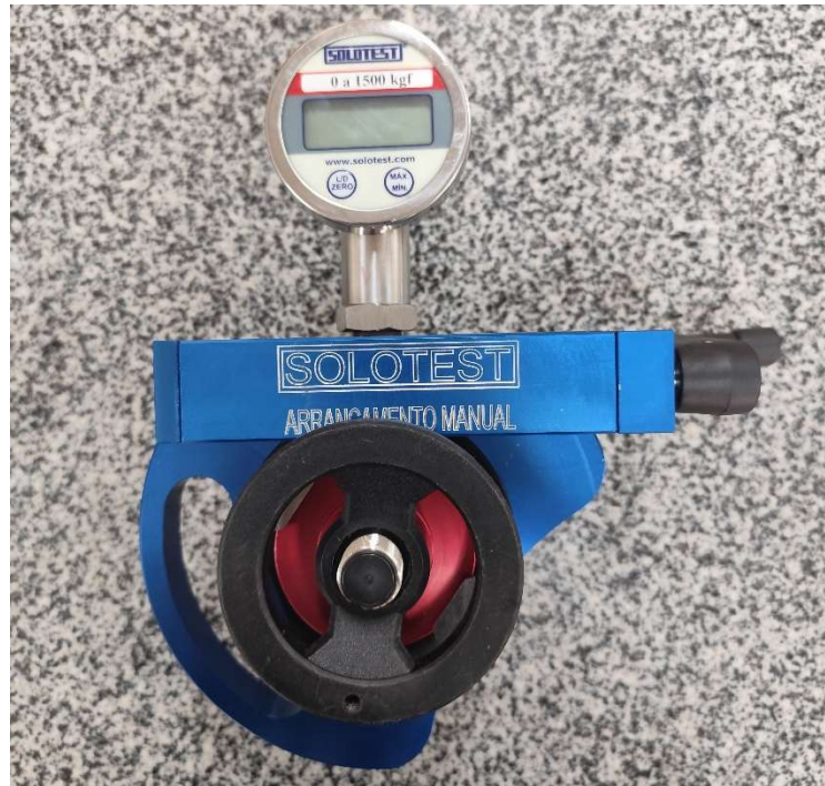
Figura 25: Aparelho para arrancamento hidráulico manual, para argamassas.
