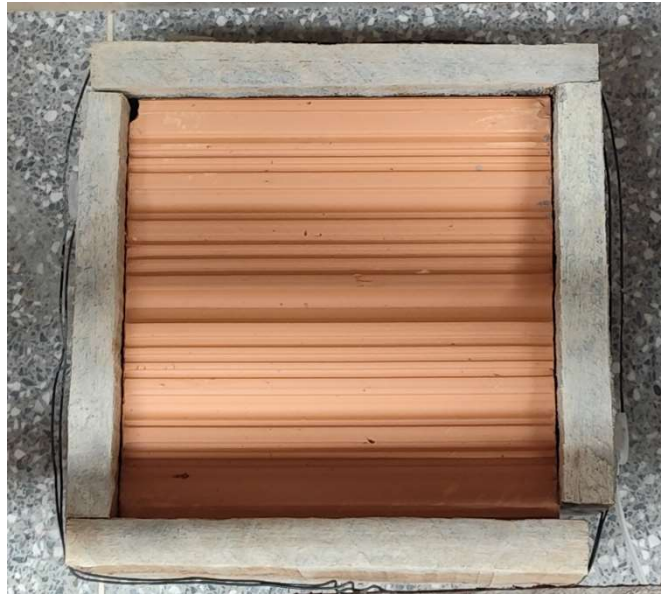
Figura 20: Bloco cerâmico encaixado no molde de madeira.
