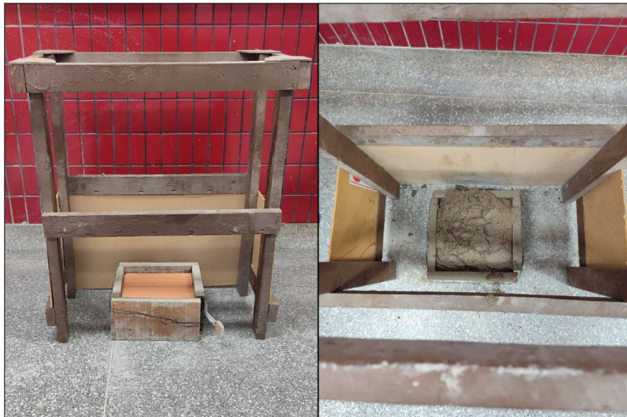
Figura 21: Estrutura de madeira para lançamento da argamassa.
