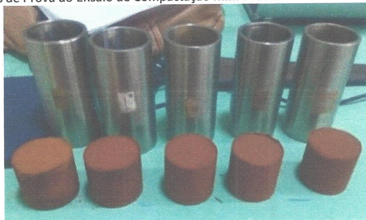
Figura 19 - Corpos de Prova do Ensaio de Compactação Mini-Proctor.
