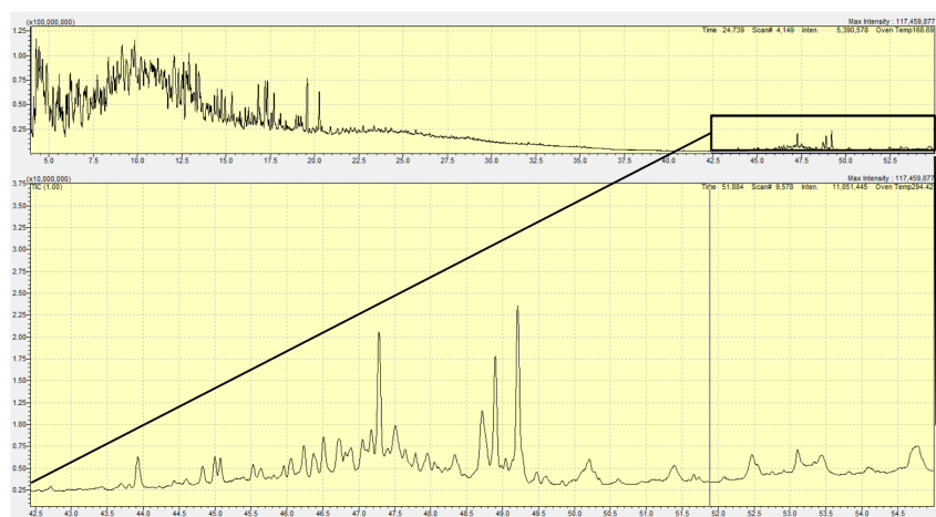
Figura 8 - Cromatograma da cera de ouvido no teste 1. O espectro apresenta o perfil cromatográfico da alíquota de 10 ug de cera de ouvido após o processo de extração utilizando-se a proporção de 5 mL de hexano para 1 mL de acetona.
