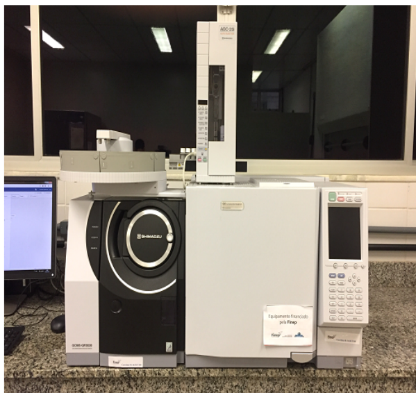
Figura 7 - Cromatógrafo gasoso acoplado a espectrômetro de massas. Esta figura mostra o equipamento disponível no laboratório 114 da Universidade Federal do Oeste da Bahia - UFOB, campus Reitor Edgard Santos.
