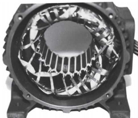
Figura 4 – Estator típico de um motor de indução
