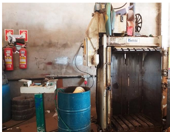
Figura 22– Painel de controle da prensa, Tonel de água usado na prensagem e Prensa horizontal.
