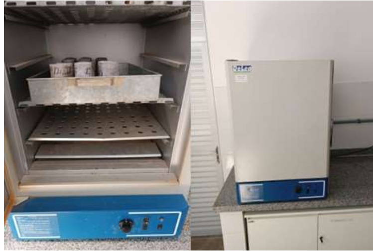
Figura 15 - Secagem dos corpos de provas em estufa a 105 °C
