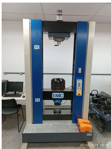
Figura 13 - Máquina universal da marca EMIC, modelo DL 30000
