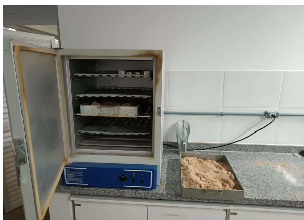
Figura 2 - Secagem de agregado miúdo em estufa
