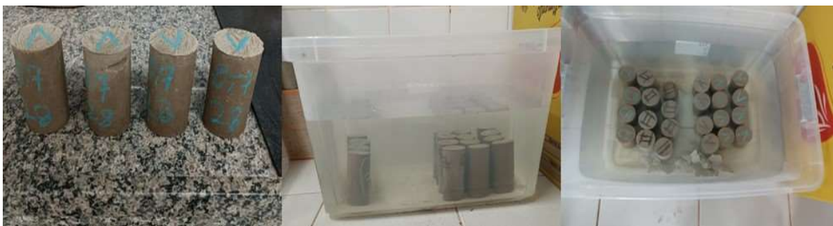
Figura 12 - Identificação dos corpos de provas e cura submersa
