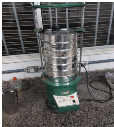
Figura 3 - Peneiras encaixadas sobre o agitador mecânico
