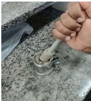
Figura 10 - Moldagem corpo de prova cilíndrico
