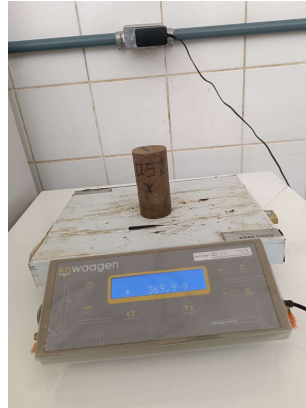
Figura 17 - Determinação da massa saturada
