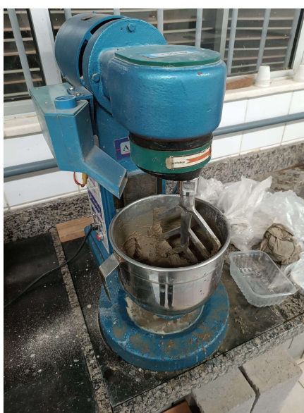
Figura 8 - Mistura da argamassa no misturador mecânico
