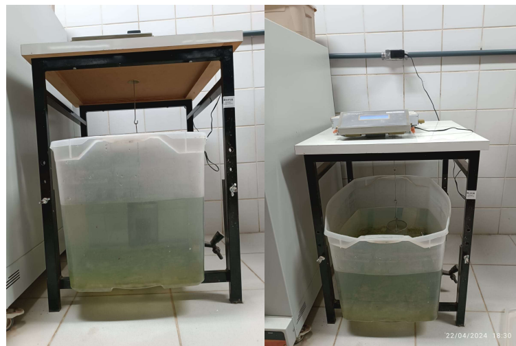
Figura 16 - Pesagem dos CP's submerso em balança hidrostática
