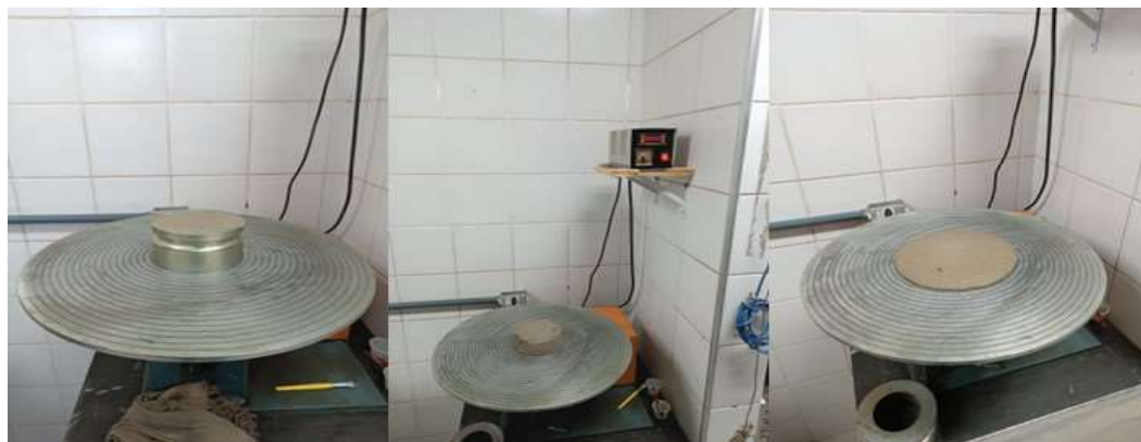
Figura 9 - Determinação do índice de consistência da argamassa
