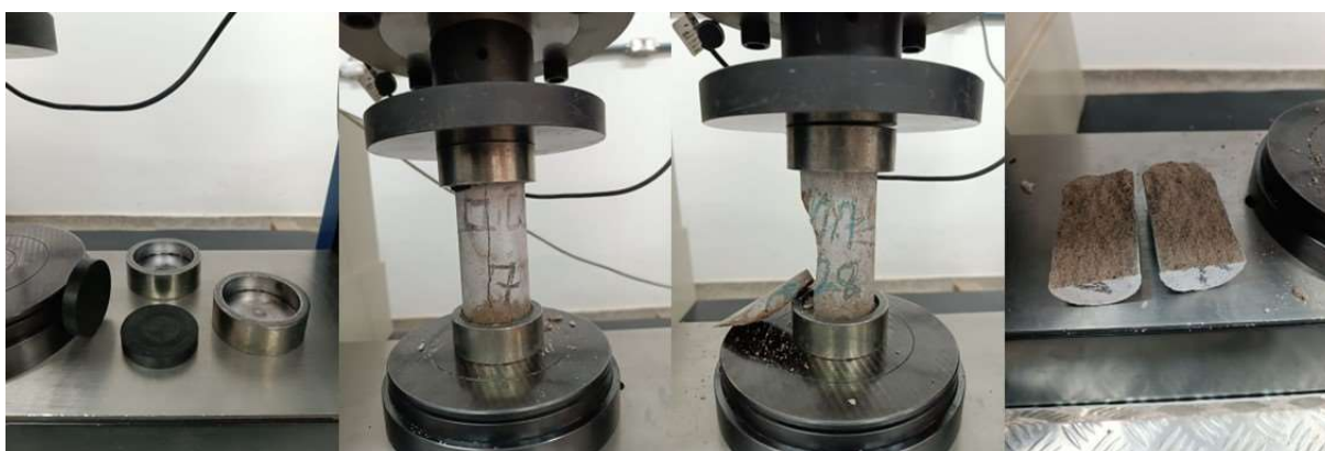
Figura 14 - Ruptura do corpo de prova com pratos metálicos e discos de neoprene shore 70
