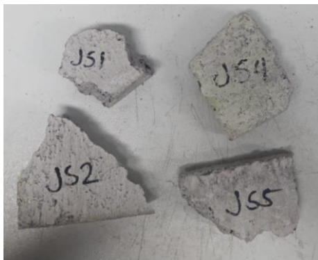
Figura 21: Amostras dos blocos rompidos no ensaio de resistência à compressão.
