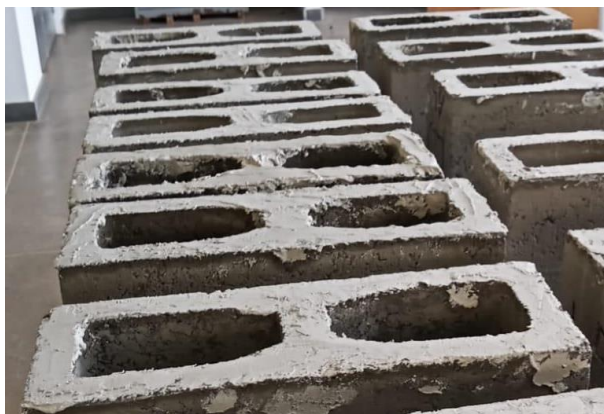
Figura 24: Blocos após o processo de capeamento com gesso.
