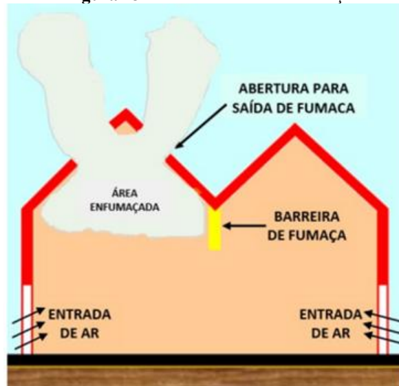
Figura 13 - Entrada e Saída de fumaça
