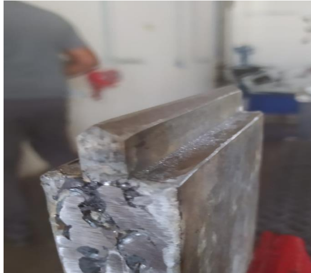
Figura 15- Cutelo acoplado ao martelo
