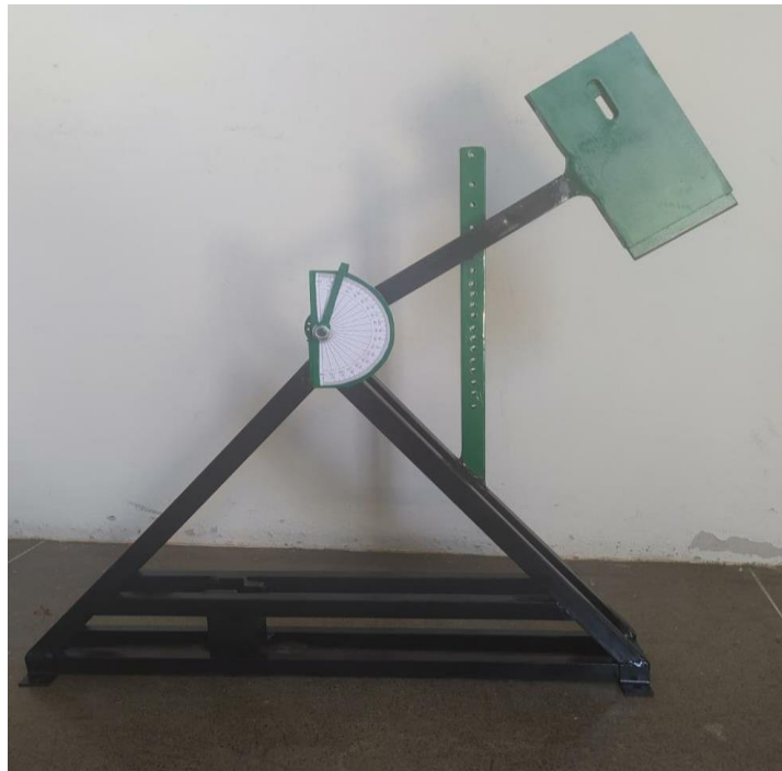
Figura 23- Máquina de ensaio de impacto de baixo custo
