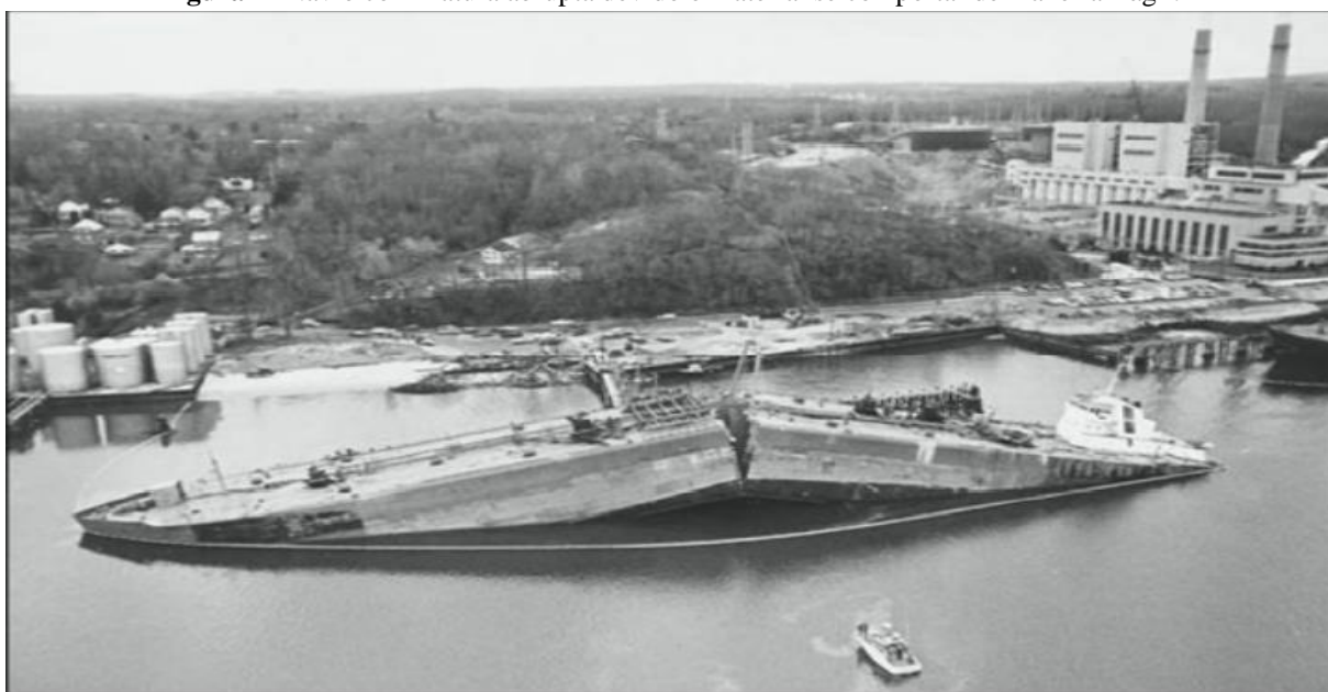
Figura 1- Navio com fratura abrupta devido o material se comportar de maneira frágil.
