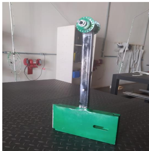
Figura 18- Conjunto (haste, eixo e martelo)
