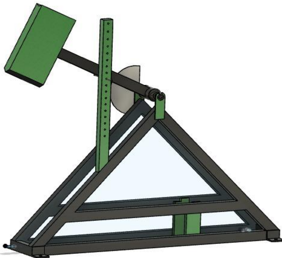
Figura 12- Modelo real do equipamento de ensaio de impacto
