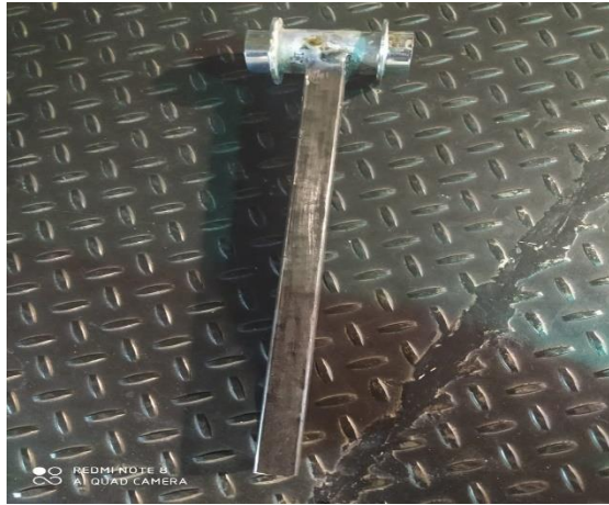
Figura 17- Haste soldada ao eixo.
