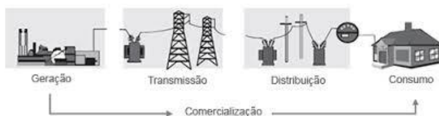
Figura 1 - Sistema Elétrico de Potência
