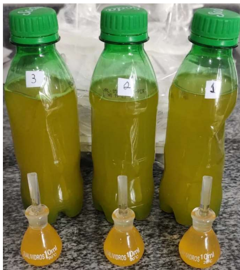
Figura 5 - Determinação da densidade em triplicata.
