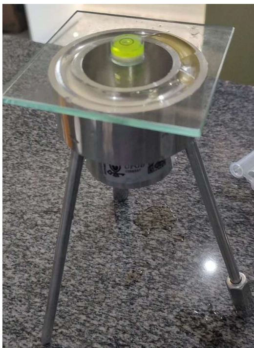
Figura 7 - Determinação da viscosidade através do Copo Ford.
