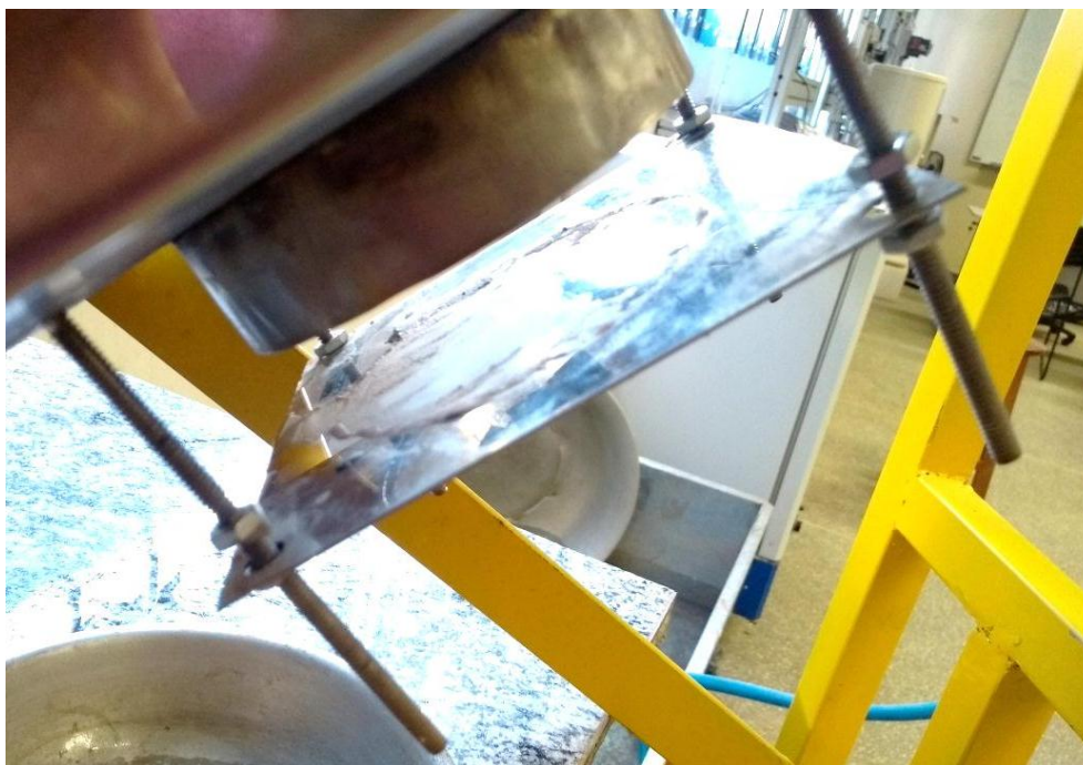
Figura 20 - Detalhe da placa do Aparelho de Inderbitzen utilizado nos ensaios.
