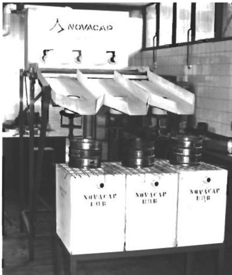
Figura 4 - Aparelho Inderbitzen modificado desenvolvido por Fácio em 1991.
