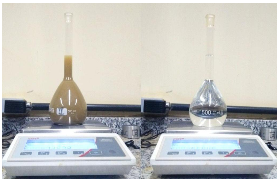
Figura 16 - Etapa do ensaio de massa específica em andamento.
