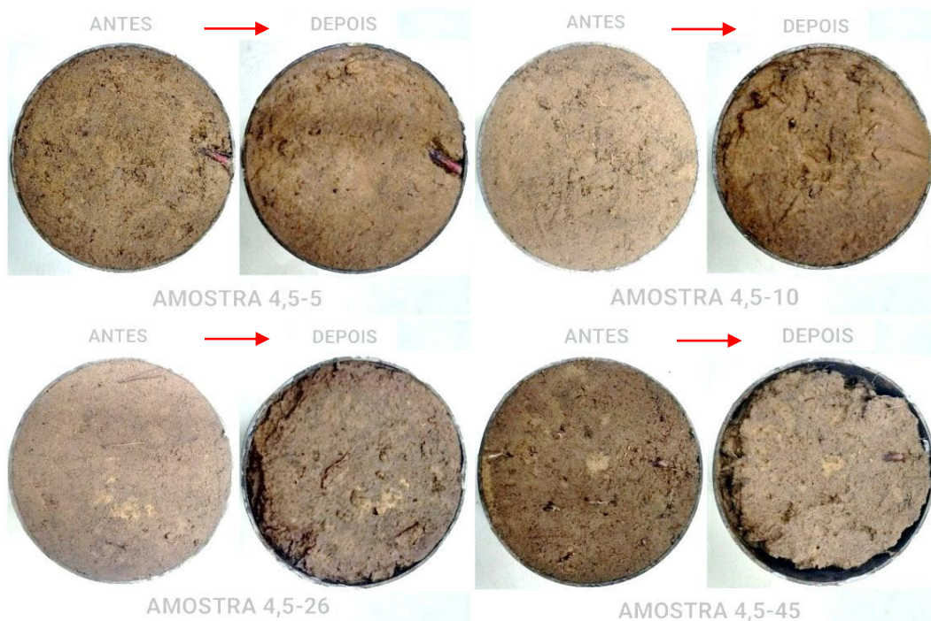
Figura 29 - Amostras antes e depois do ensaio de Inderbitzen para a vazão de 4,5 l/min.
