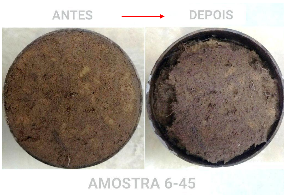
Figura 22 - Amostra 6-45 para Ensaio de Inderbitzen (vazão: 6 l/min; inclinação: 45°).
