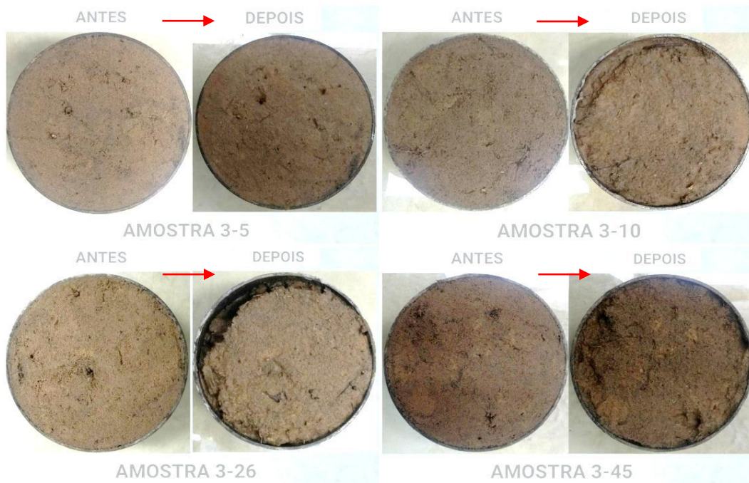
Figura 28 - Amostras antes e depois do ensaio de Inderbitzen para a vazão de 3 l/min.
