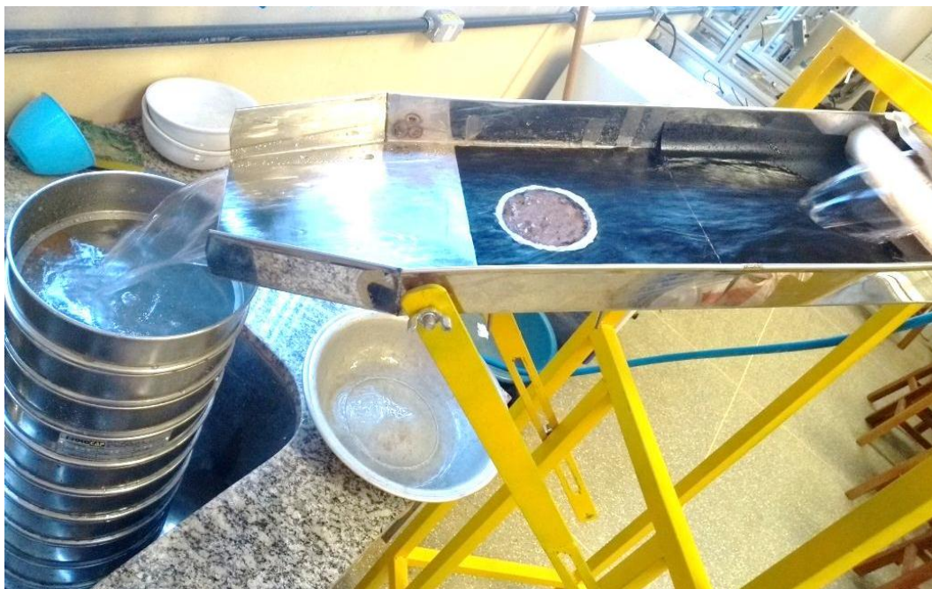
Figura 21 - Ensaio de Inderbitzen em andamento.
