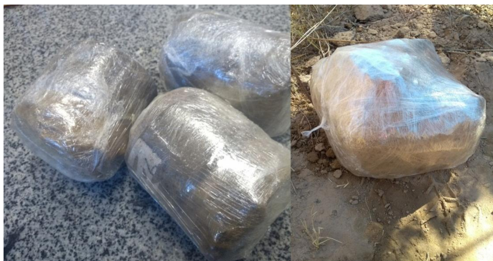
Figura 15 - Amostras indeformadas cobertas por papel filme.
