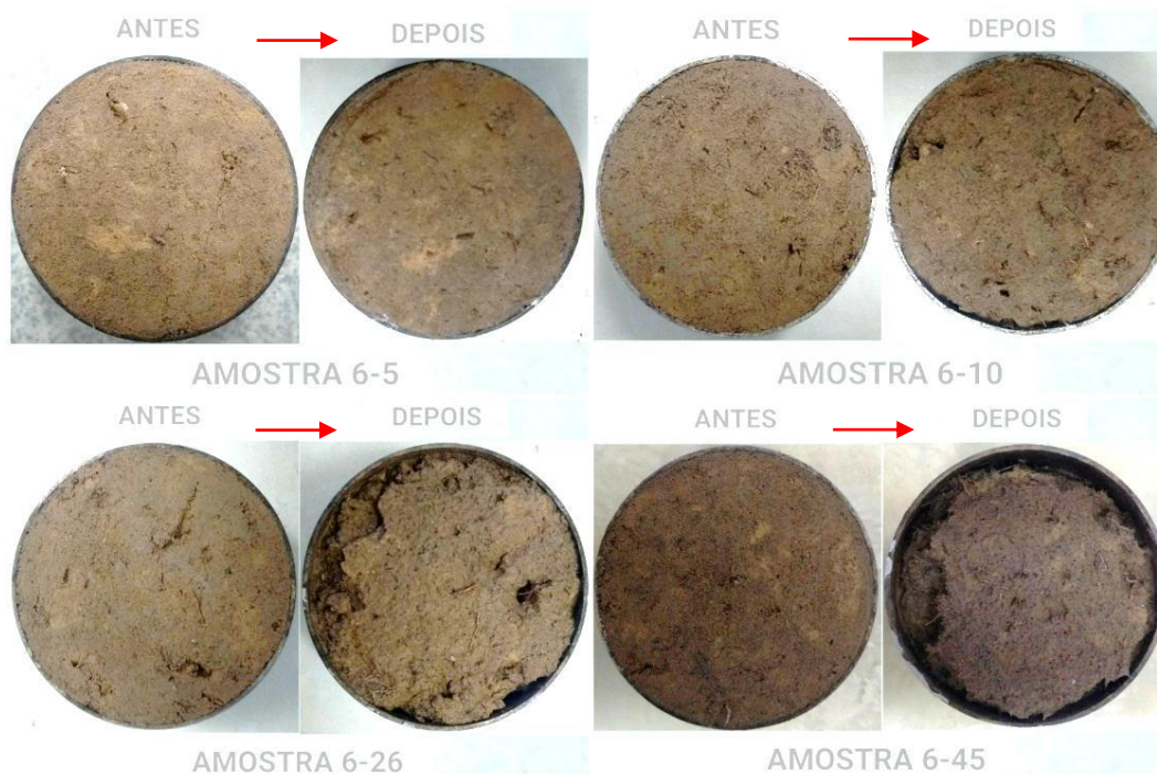
Figura 30 - Amostras antes e depois do ensaio de Inderbitzen para a vazão de 6 l/min.
