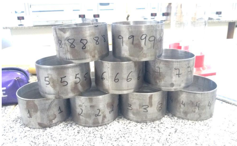
Figura 19 - Anéis de aço utilizados no ensaio de Inderbitzen.
