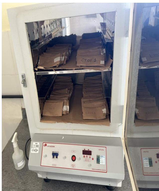
Figura 5. Amostras posicionadas para secagem em estufa. Imagem: Autora (2024).
