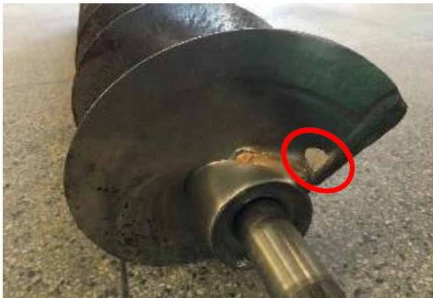
Figura 11- Desgaste abrasivo em mecanismo de transporte de máquina colhedora de grãos
