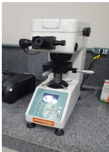
Figura 19- Microdurômetro utilizado para ensaio de dureza vickers.
