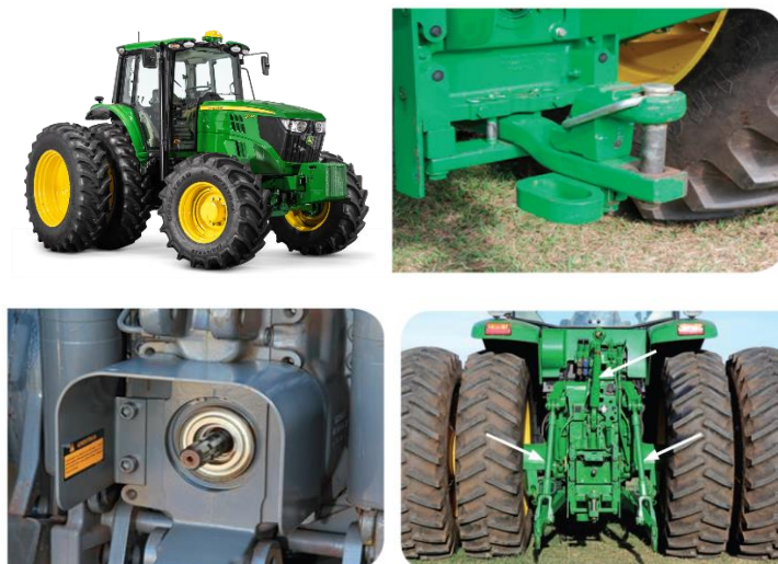
Figura 3 Trator (a), Barra de tração (b), Tomada de Potência (c) e Sistema hidráulico de três pontos (d)
