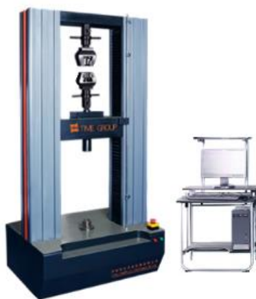
Figura 18- máquina universal de ensaio de tração marca ARMS-FIND modelo WDW-B100
