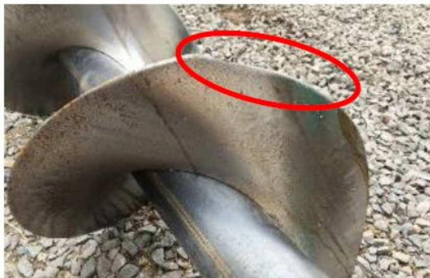
Figura 12-Redução das dimensões do mecanismo helicoidal devido ao desgaste abrasivo
