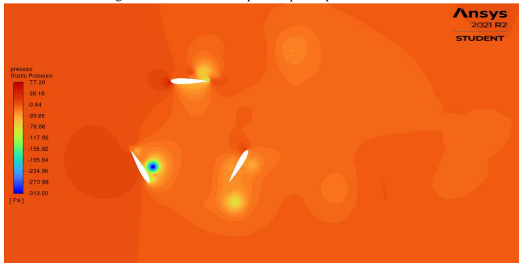
Figura 4.11 – Contorno de pressão para o perfil NACA0015
