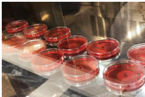
Figura 5. Adição da solução de vermelho congo aos fungos inoculados em meio CMC. Fonte: Elaborado pela autora (2023).
