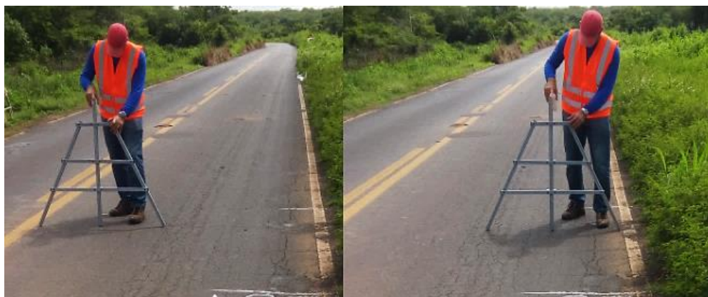
Figura 15 - Medidas na trilha externa e interna da superfície de avaliação 84, do segmento 14.
