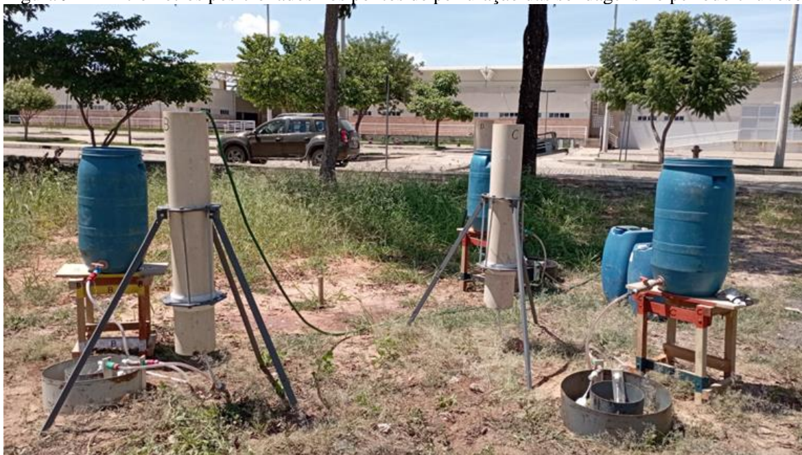
Figura 9 – Infiltrômetros posicionados nos pontos de perfuração das sondagens no período chuvoso.
