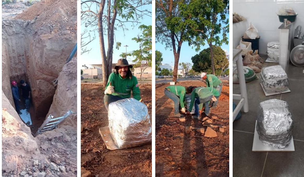
Figura 21 – Etapas de preparação de um corpo de prova de cisalhamento em amostra indeformada.
