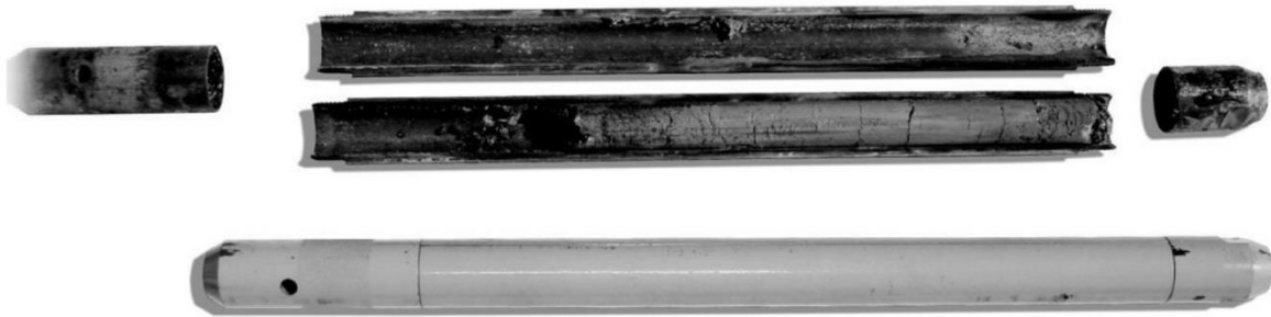
Figura A1: Amostrador padrão bipartido aberto com amostra de solo e fechado.
