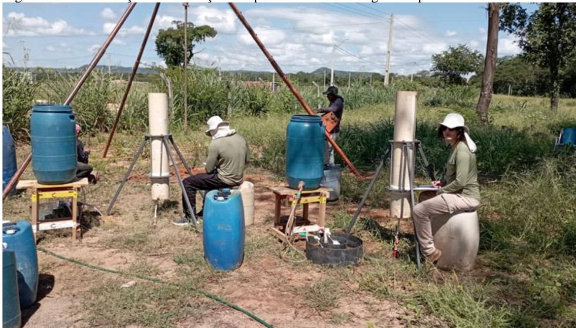
Figura 10 – Continuação da infiltração nos pontos 2 e 3 e sondagem no ponto 1 em andamento.
