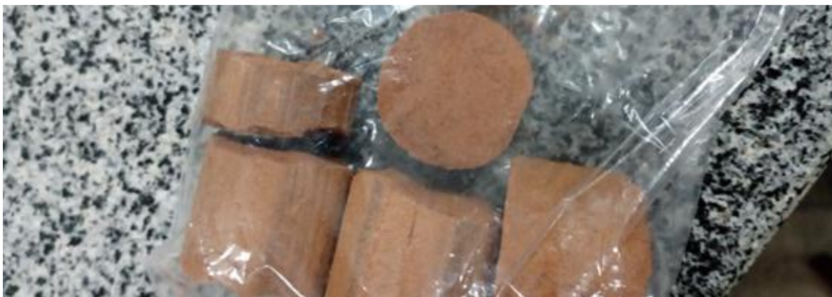
Figura 12 – Amostras coletadas do amostrado condicionadas em saco para preservar umidade
