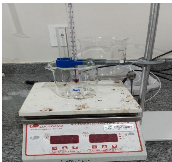
Figura 8 - Sistema adaptado para análise do ponto de ebulição.
