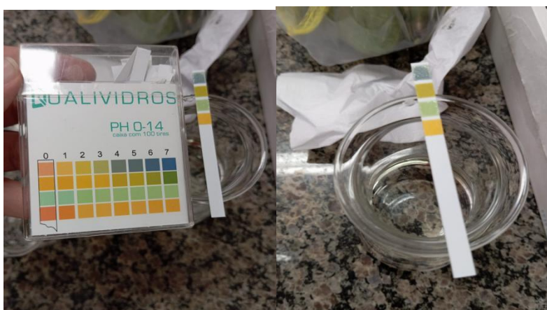
Figura 10 - Resultado da imersão da fita reagente comparada com o padrão da caixa.
