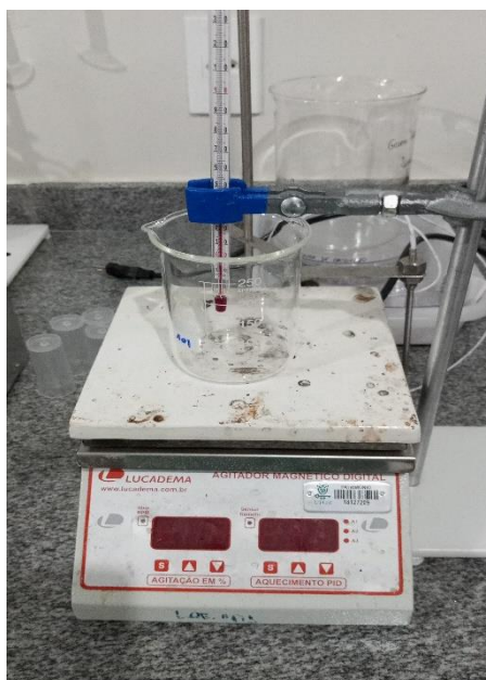
Figura 9 - Sistema para determinação do Flashpoint .
