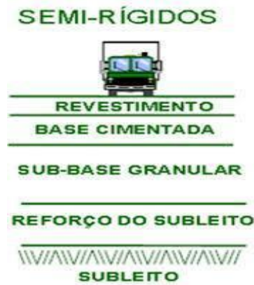
Figura 3: Pavimento semi-rígido (corte longitudinal).
