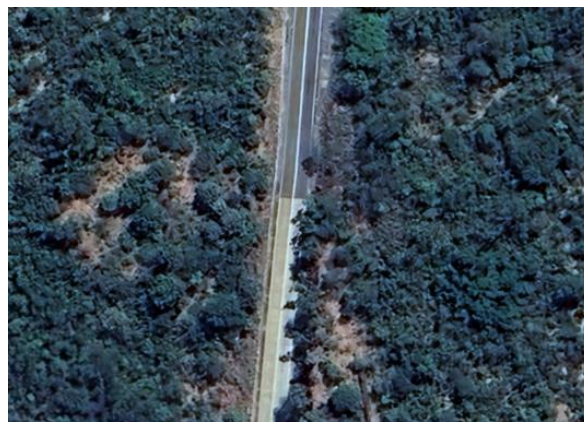
Figura 34: Limites entre o pavimento rígido e o pavimento flexível.
