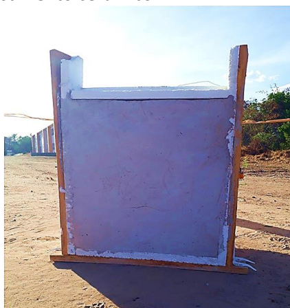
Figura 59 - Parede móvel sem revestimento cerâmico.
