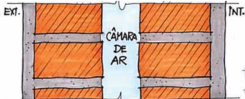
Figura 44 - Representação de uma parede dupla com câmara de ar.
