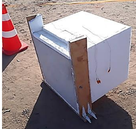
Figura 60 - Parede móvel sem o revestimento limitada por placas de poliestireno (isopor).
