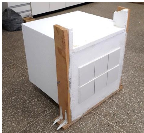
Figura 55 - Parede móvel delimitada com placas de isopor.
