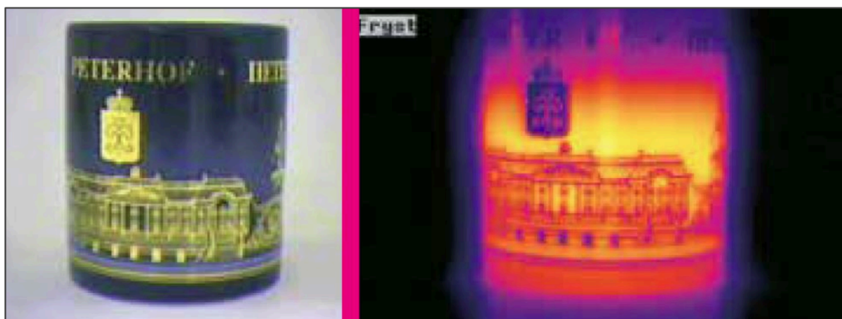
Figura 3 - Termograma de objeto com áreas de diferentes emissividades
