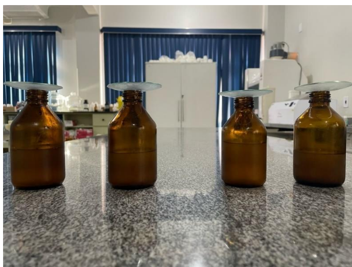
Figura 11 – Amostras retiradas do Freezer após ciclo de 24h a uma temperatura de -5 \pm 2^\circ \text{C} em Teste de Estabilidade Preliminar, tendo vidros de relógio como tampa tanto no ciclo do freezer como no ciclo de estufa.
