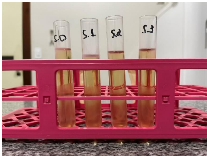
Figura 7 – Amostras após serem submetidas ao teste de centrifuga, demonstrando alteração em sua estrutura.
