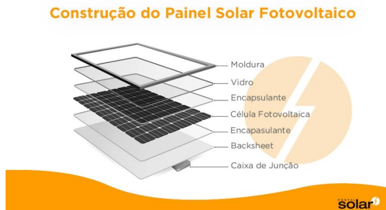
Figura 9 Construção do Painel Solar Fotovoltaico
