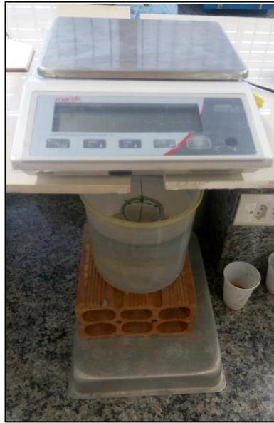
Figura 26 – Balança com dispositivo para realização da determinação da massa submersa das amostras.
