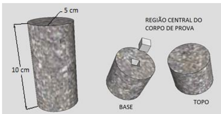
Figura 25 - Representação da extração da amostra para ensaio de porosidade.
