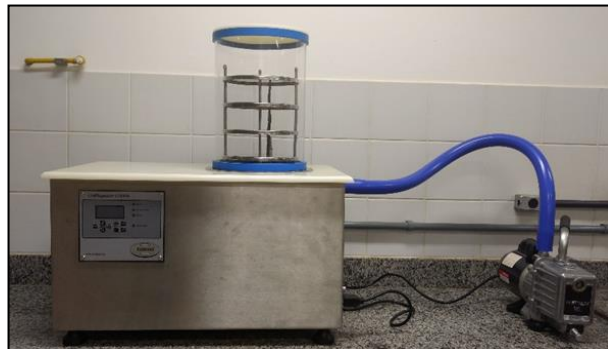
Figura 27 – Liofilizador utilizado para a sublimação da água congelada contida nos poros da argamassa.
