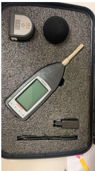
Figura 18- Caixa, a qual contém o medidor sonoro, calibrador e o protetor de vento
