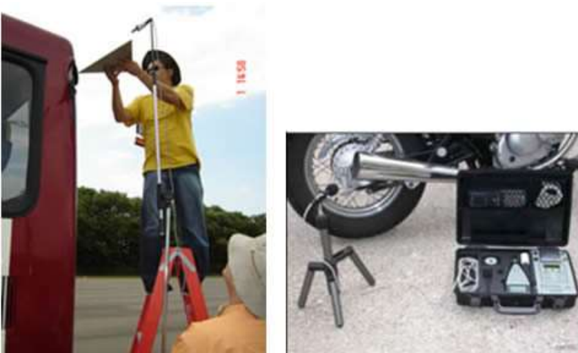
Figura 10- Procedimento de verificação do nível de ruído
