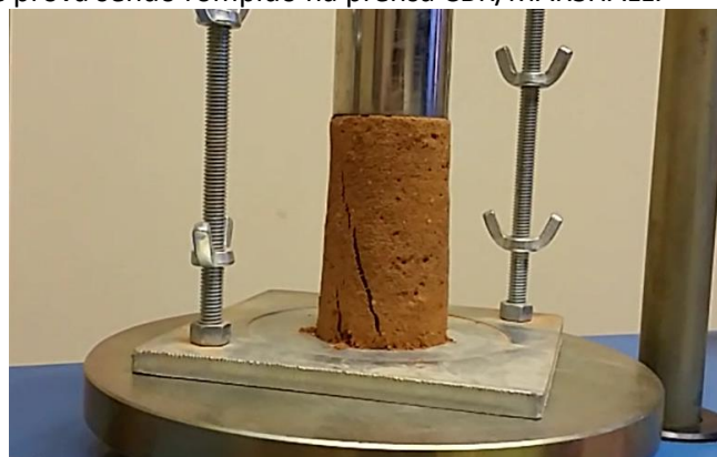
Figura 28 - Corpo de prova sendo rompido na prensa CBR/MARSHALL.
