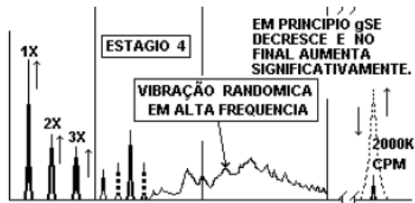
Figura 34 – Espectro típico de rolamento - estágio 3
