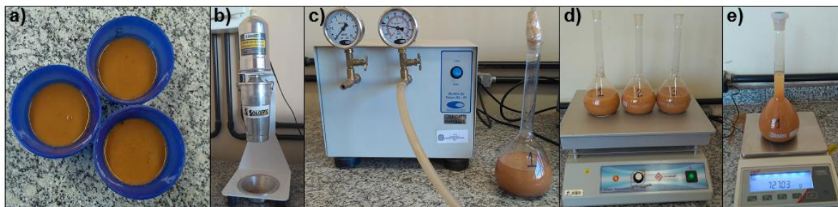
Figura 14 - Ensaio de massa específica dos grãos: a) etapa de saturação 12h; b) dispersão; c) Remoção de ar com bomba a vácuo; d) Aquecimento em chapa; e) Pesagem.
