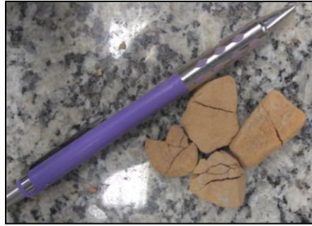
Figura 26 - Fratura do RCD após compactação e CBR.
