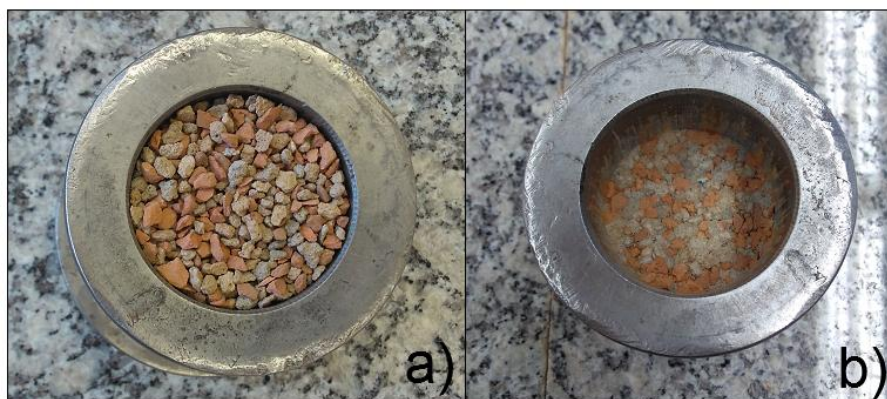
Figura 30 - Amostra de RCD: (a) antes do ensaio e (b) após o ensaio de compressão unidimensional com tensão vertical de 10.000 kPa.
