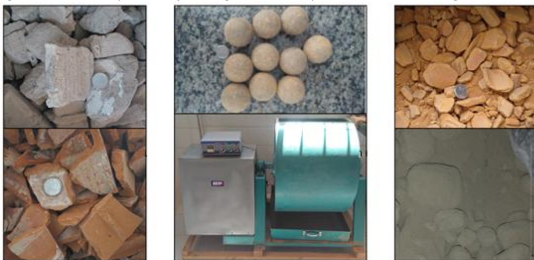
Figura 13 - Processo para redução dos grãos com máquina de Abrasão Los Angeles
