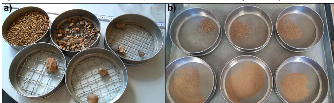
Figura 16 – Amostras de solo retido nas peneiras: a) peneiramento grosso; b) peneiramento fino.
