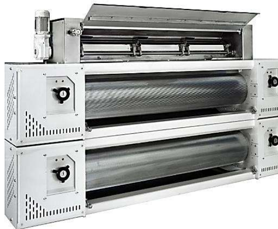
Figura 3 - Estrutura interna do Moinho de quebra
