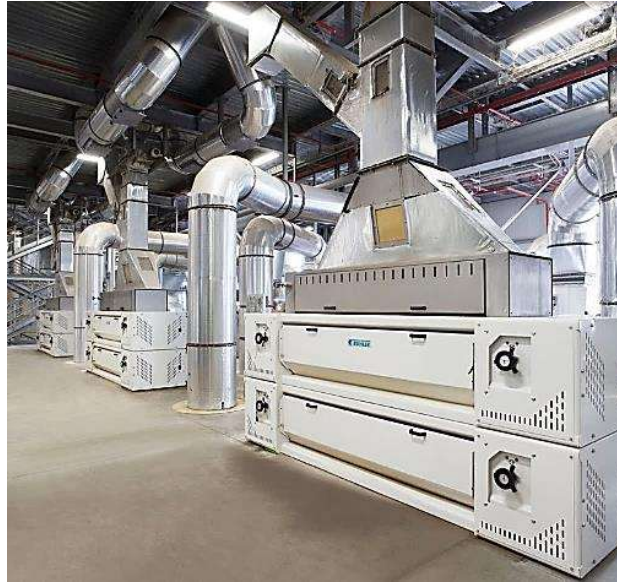
Figura 4 – Estrutura externa do Moinho de quebra
