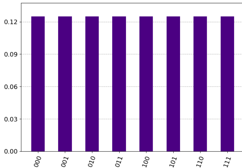
Figura 13 – Histograma das probabilidades obtido ao aplicar a QFT em uma simulação no estado |100\rangle com uso da ferramenta myQLM
