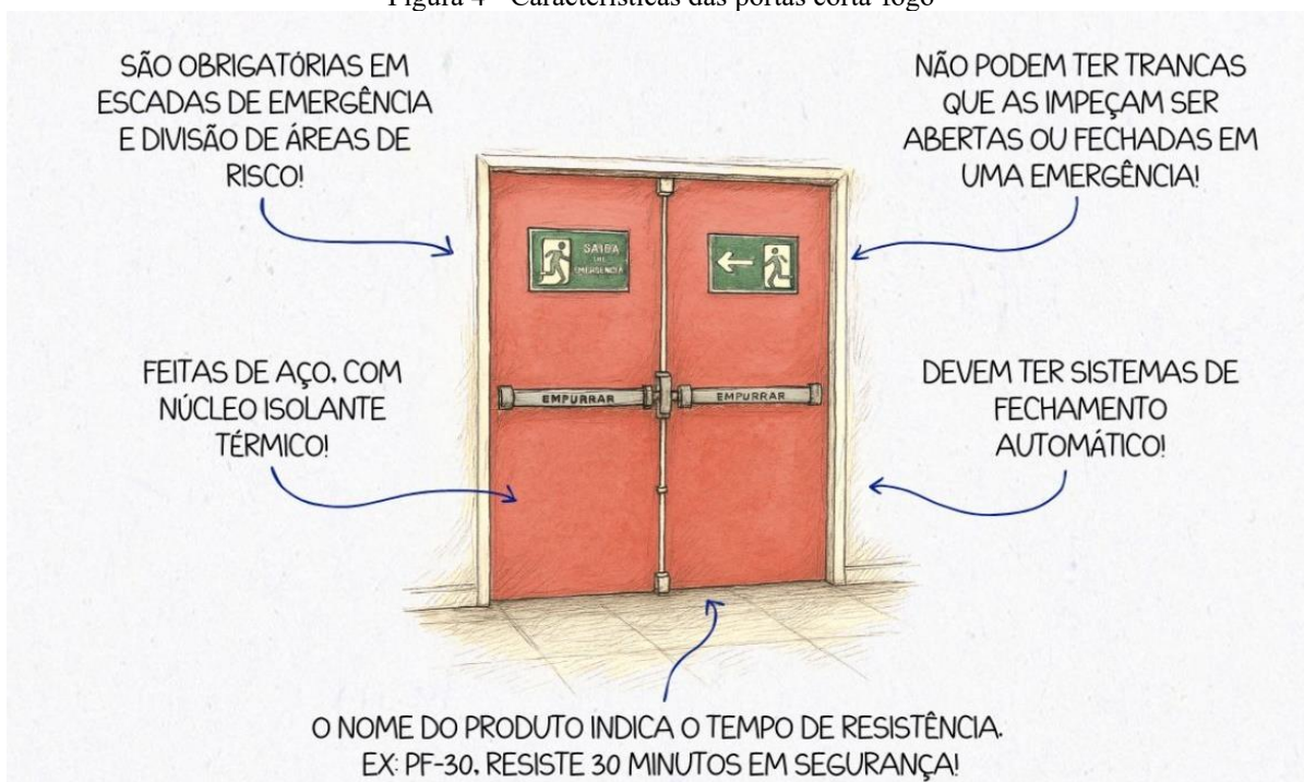
Figura 4 - Características das portas corta-fogo
