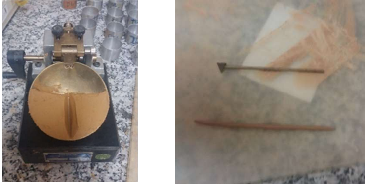
Figura 12 - a) ensaio de limite de plasticidade, b) ensaio de liquidez pelo método de Casa Grande e c) Amostras dos ensaios de Limite de Liquidez e Limite de Plasticidade secando na estufa a 110°.
