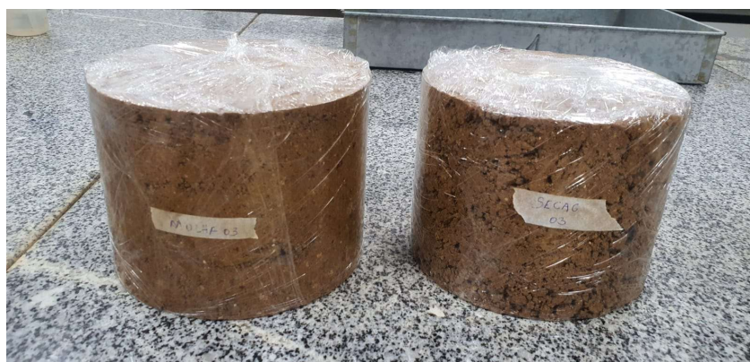
Figura 17 - Amostras de solo compactadas com energia Proctor Normal. À esquerda, mais homogêneo, está a amostra preparada por molhagem, e à direita, com perceptíveis vazios, amostra preparada por método de secagem.
