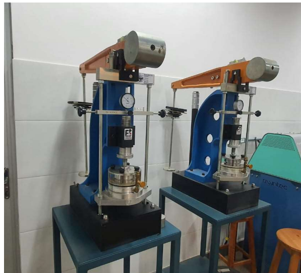
Figura 19 - ensaio de adensamento do solo realizado em duas amostras preparadas por metodologias distintas.
