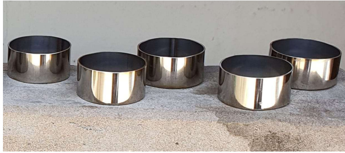
Figura 20 – Cilindros de moldagem para ensaio de absorção de água pelo método do papel filtro.
