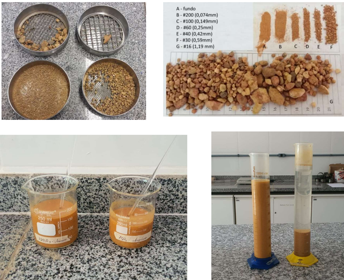
Figura 13 - Ensaio de Granulometria a) peneiramento grosso, b) peneiramento fino, c) preparação de amostra com e sem defloculante e d) ensaio de sedimentação com e sem defloculante após 24h.
