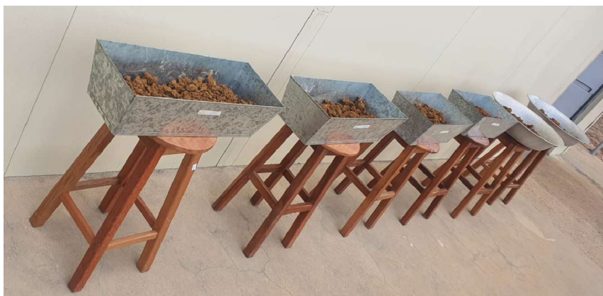
Figura 16 - Preparação do solo para compactação pelo método de Secagem. a) solo úmido e b) amostra secando ao ar.
