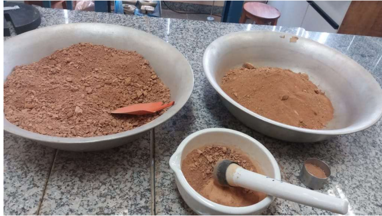
Figura 10 - Solo seco a unidade destorroado
