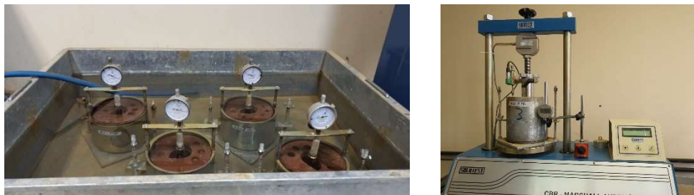
Figura 18 a) ensaio de expansão do solo b) ensaio de Índice de Suporte Califórnia - CBR
