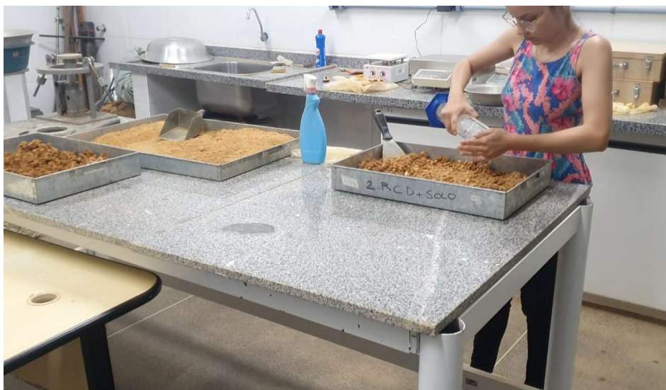
Figura 15 - Preparação do solo para compactação pelo processo de molhagem.
