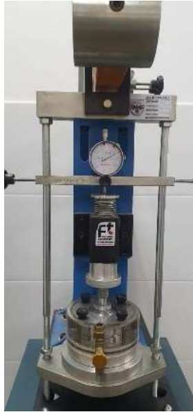
Figura 3 - Esquema do ensaio de Adensamento Endométrico (Laboratório de Geotecnia - UFOB)
