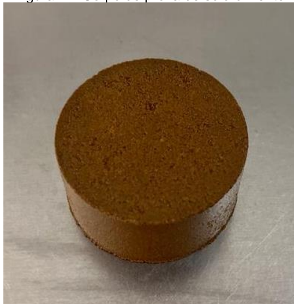
Figura 22. Corpo de prova de solo-cimento.
