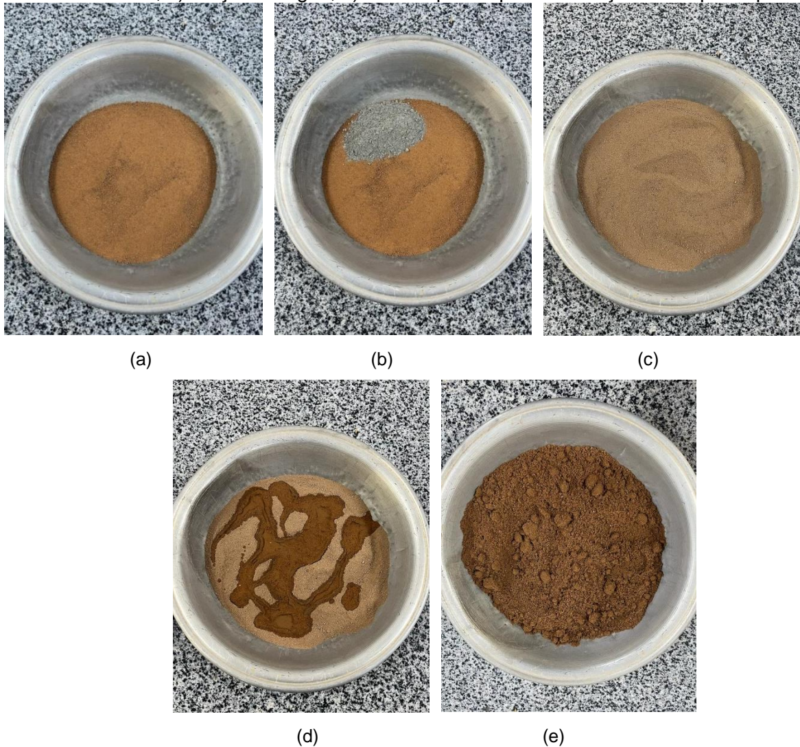
Figura 20. Preparação da mistura solo-cimento: a) Solo natural; b) Solo natural + cimento; c) Mistura dos secos; d) Adição de água; e) Mistura pronta para fabricação do corpo de prova.
