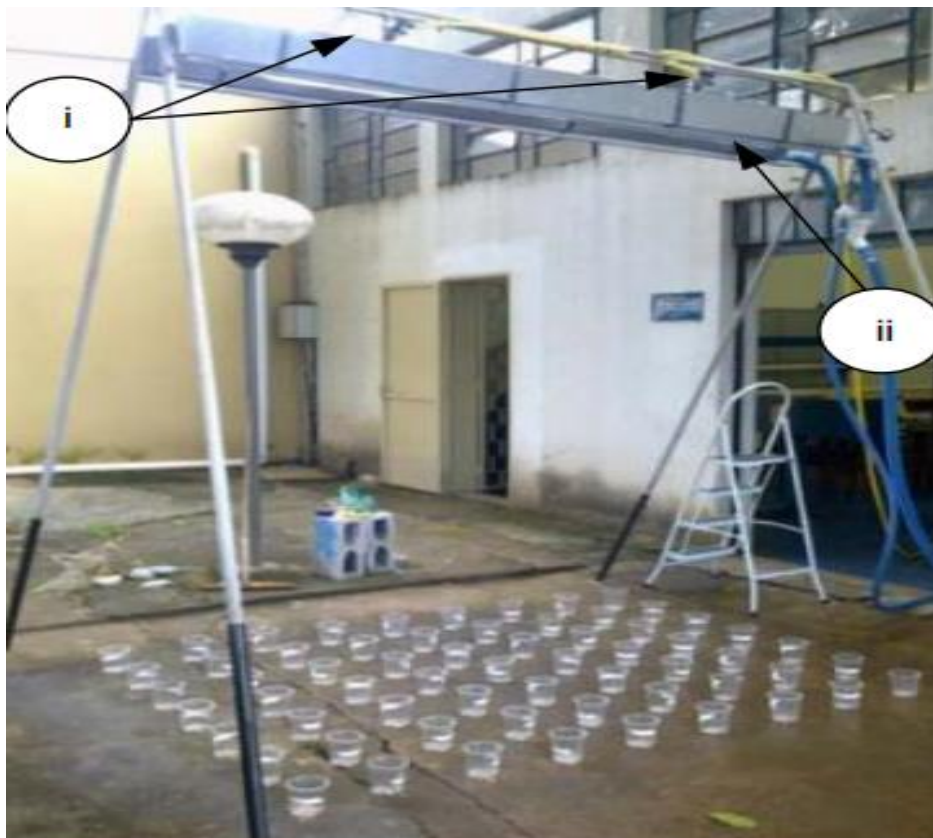
Figura 5 – Conceito do simulador de chuva de laboratório
