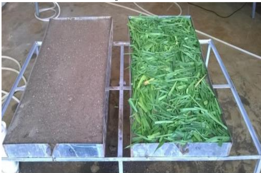
Figura 6 - Parcelas experimentais constituída de material metálico com Neossolo com a presença de cobertura vegetal e sem a cobertura.
