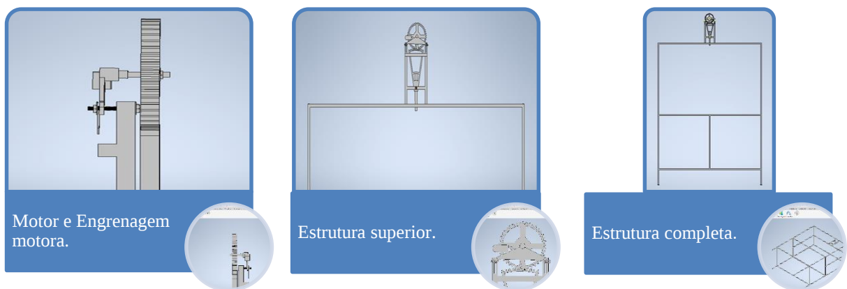
Figura 41 – Etapas de montagem do mecanismo no simulador de chuva de campo.
