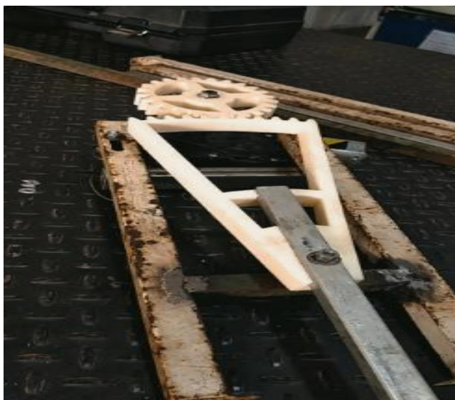
Figura 50 – Estrutura do simulador de chuva de laboratório
