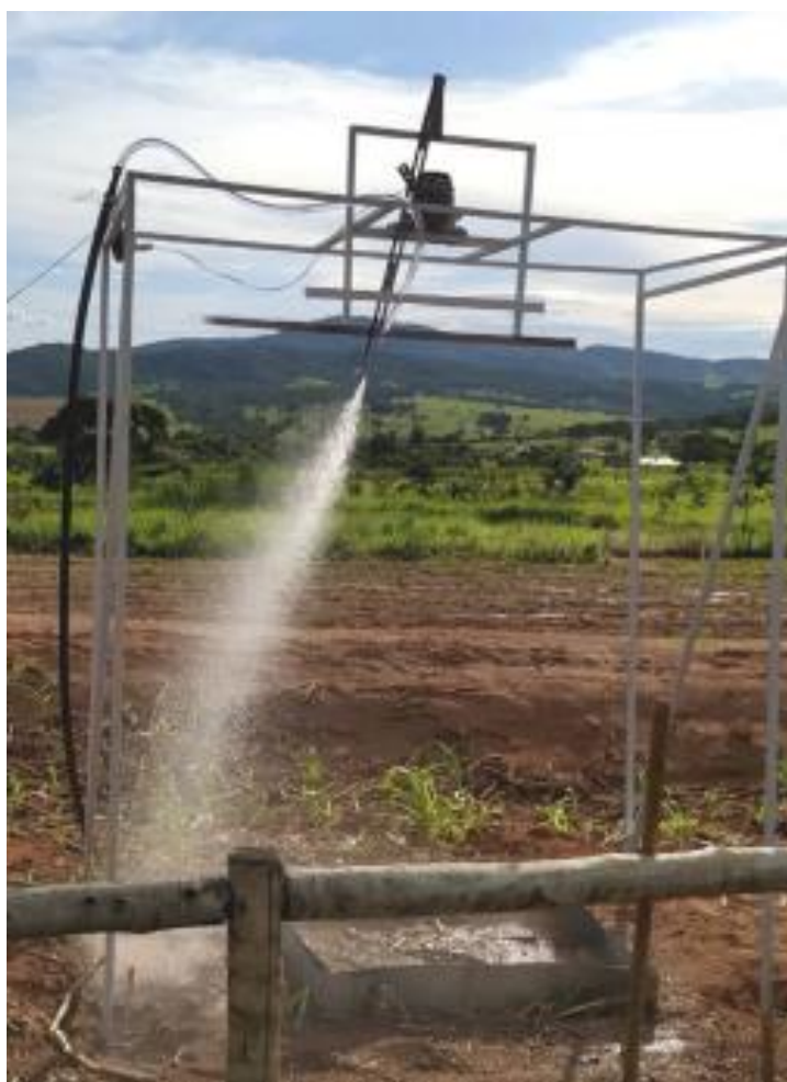
Figura 9 - Simulador de chuva montado para o teste de uniformidade do bocal do aspersor.
