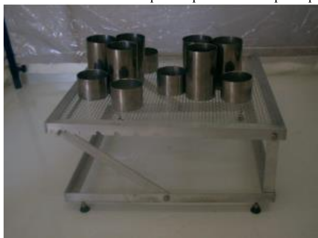
Figura 4 – Coletores de chuva e recipientes para ensaio de perda por “Splash”
