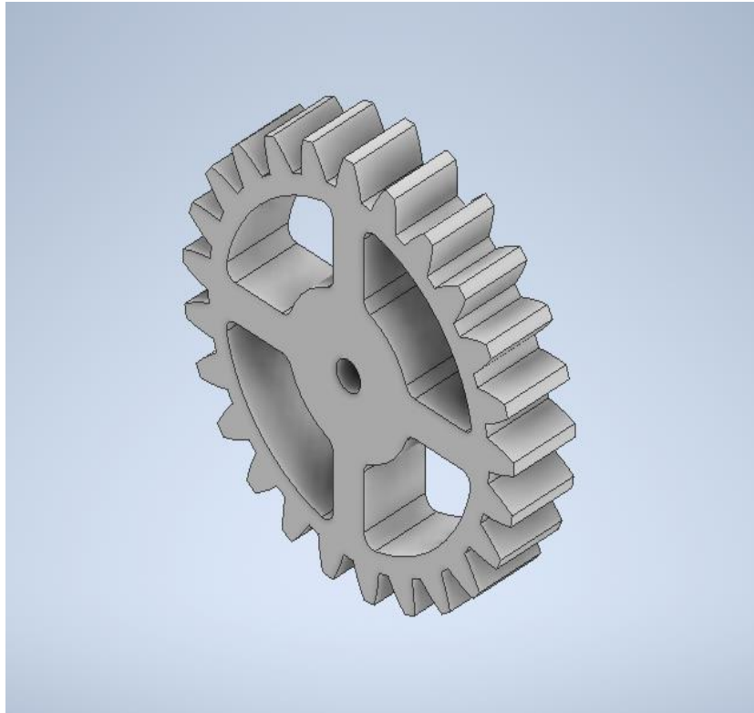
Figura 31 – Protótipo 3D da engrenagem motora menor.
