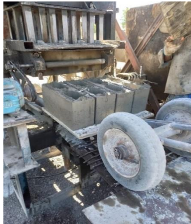
Figura 13 – Prensagem dos blocos de concreto.
