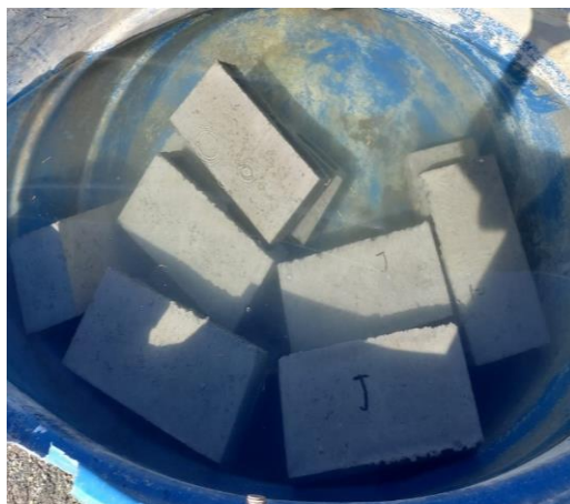
Figura 17- Blocos em cura submersa.
