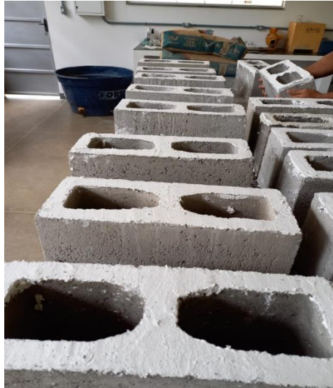
Figura 23– Capeamento dos Blocos.
