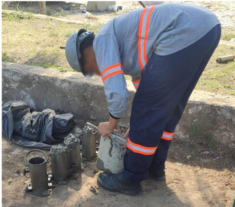
Figura 14 - Colaborador da concreteira retirando os CP's para verificação da resistência
