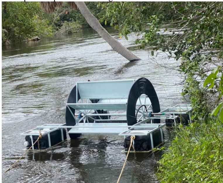
Figura 23 – Bomba espiral acoplada à roda d'água flutuante instalada no rio de Ondas.
