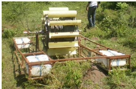
Figura 8 - Bomba de bobina helicoidal instalada em uma comunidade rural em Santander, Colômbia: (a) representação esquemática e (b) conjunto apoiado sobre a estrutura metálica.
