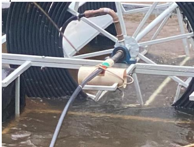
Figura 26 – Suporte confeccionado com tubo de PVC para alinhamento dos componentes do engate rápido.
