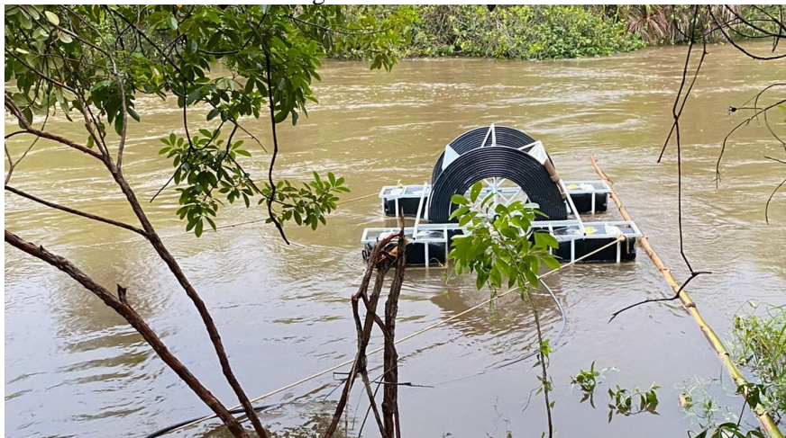
Figura 24 – Posicionamento da roda d'água flutuante com auxílio de haste de bambu.
