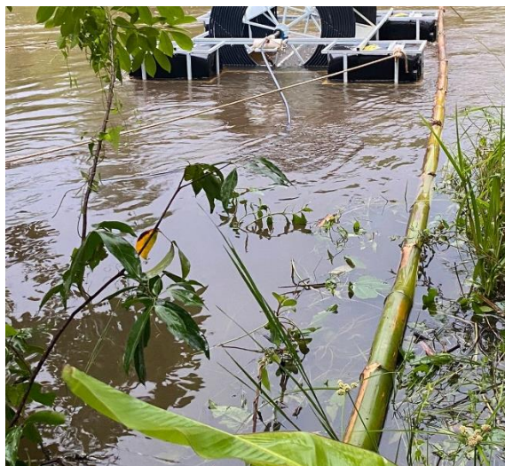
Figura 18 – Utilização de haste de bambu para o adequado posicionamento da roda d'água flutuante.
