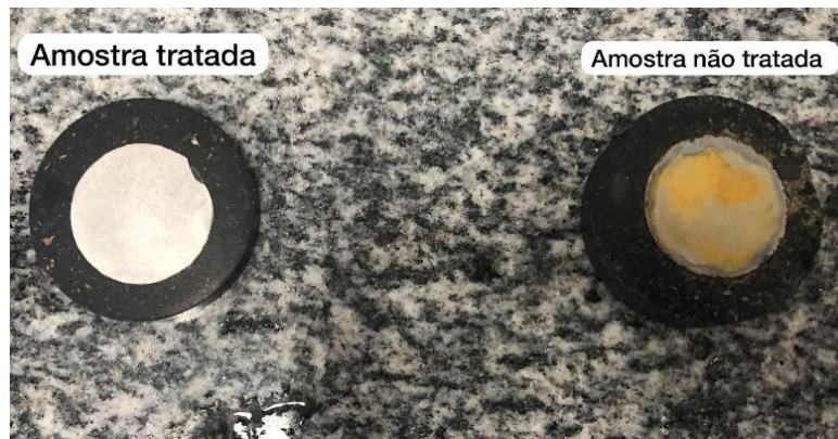
Figura 16 - Amostras após ataque químico
