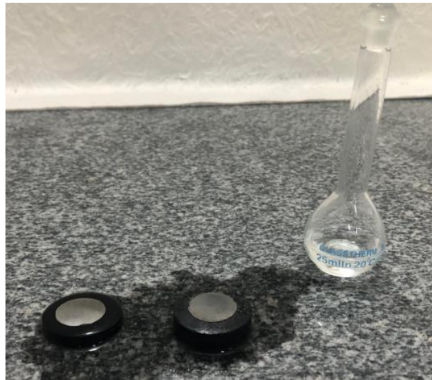
Figura 15 - Amostras recebendo ataque químico.
