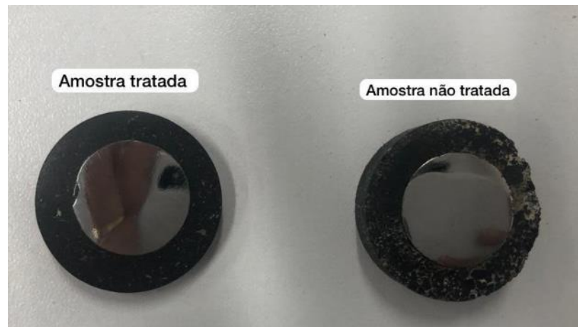
Figura 14 - Amostras embutidas, lixadas e polidas.
